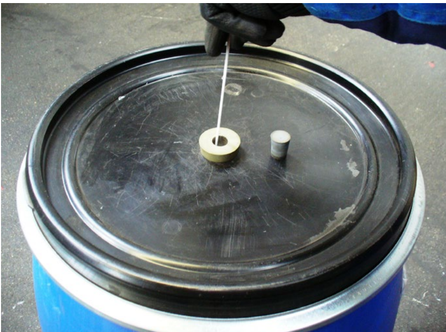
Abb. 4 Sammelfass für Bruch mit modifiziertem Spannringdeckel (Verschlussstopfen für verkleinerte Einwurföffnung)
