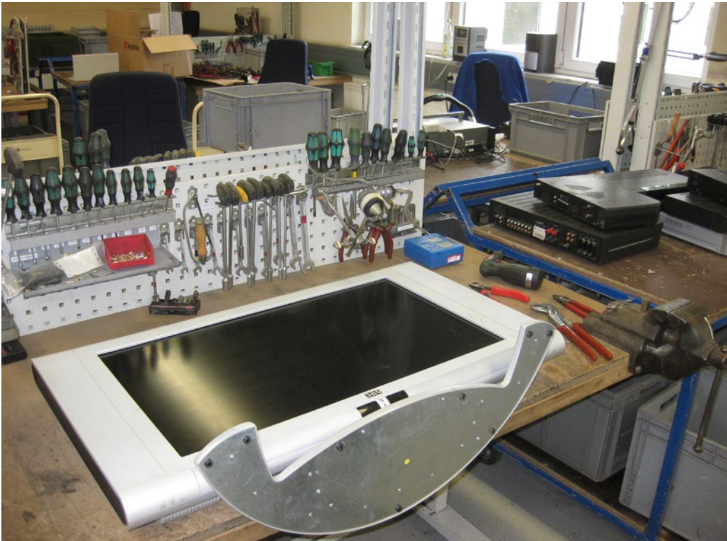
Abb. 1 Demontagearbeitsplatz (nicht abgesaugt)
