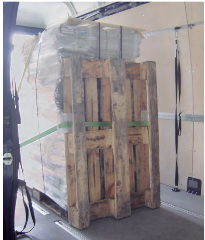
Die Kopfschlinge mittels Zurrurt und Palette fängt die Kräfte in Fahr- richtung auf.
