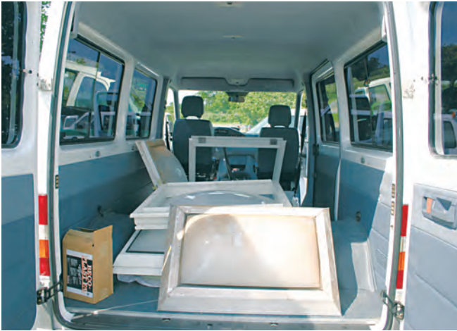
Diese Dachluken können die Fahrzeuginsassen verletzen.
