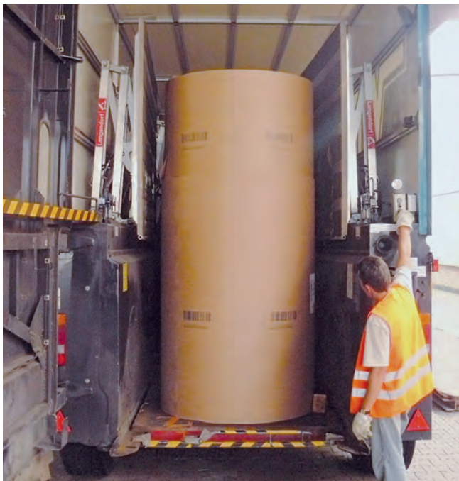
Die Rollen stehen auf Gleitschlitten, die durch Luftdruck angehoben werden. Sie werden vollautomatisch auf das Fahrzeug geschoben.
