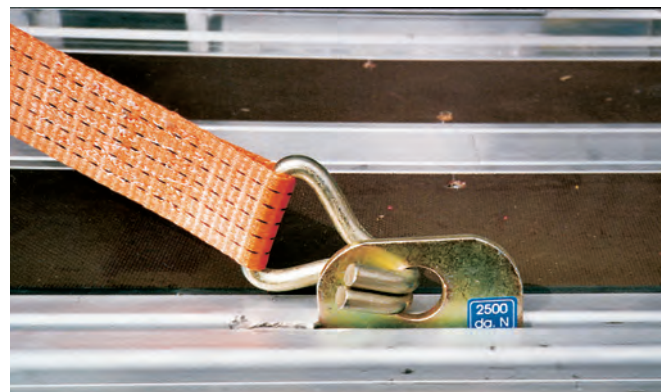
Rungentaschenreihe mit Zurrloch; Belastung Zurrlöcher 2.000 daN
