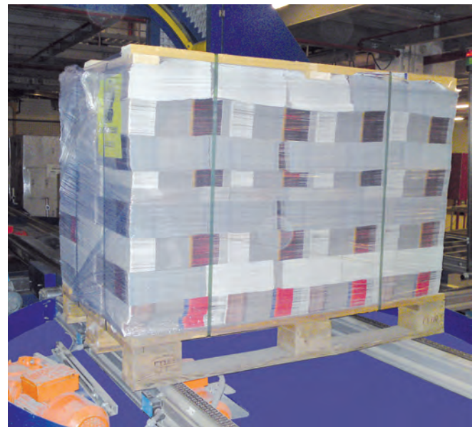
Palette mit Kopfplatte, Umreifung und horizontaler Folienstretschung
