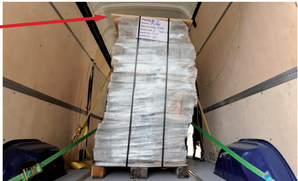
Die Kopfschlinge mittels Zurrurt und Palette fängt die Kräfte in Fahr- richtung auf.
