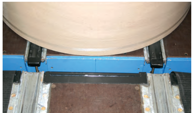
Die Rollen stehen auf Gleitschlitten, die durch Luftdruck angehoben werden. Sie werden vollautomatisch auf das Fahrzeug geschoben.
