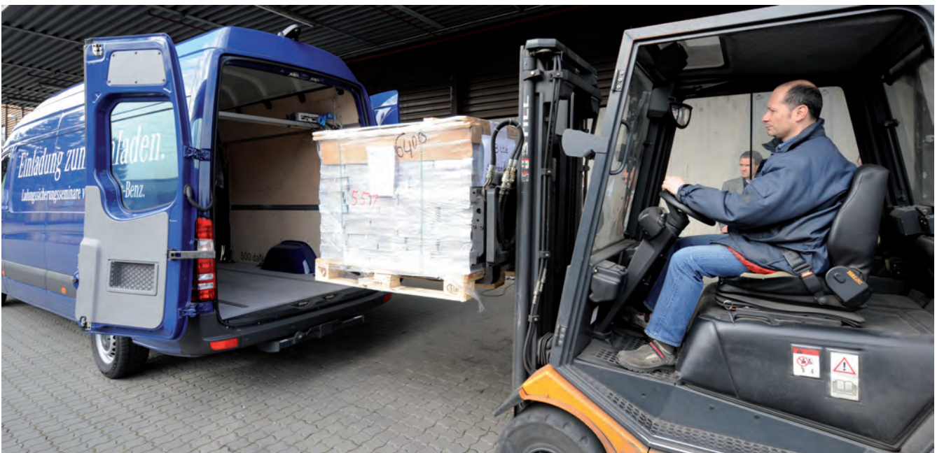
Beladung des Versuchsfahrzeuges. Da die Paletten bis kurz vor die Hinterachse geschoben werden mussten, konnten keine Anti-Rutsch-Matten eingesetzt werden.
