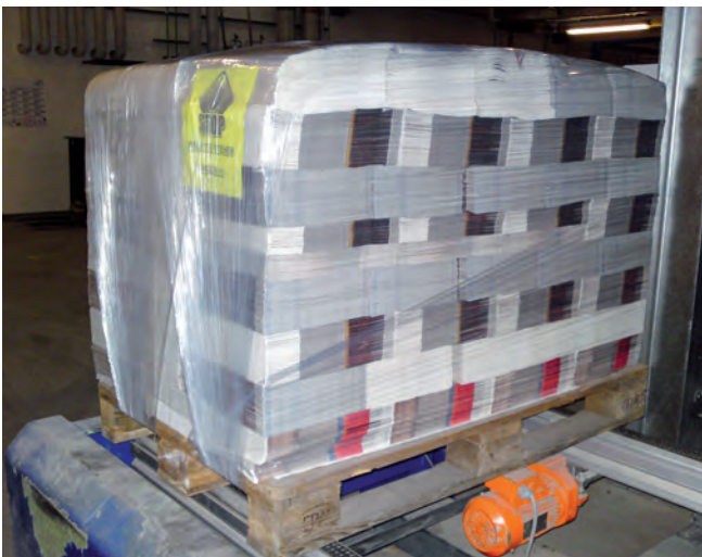
Kombination aus Horizontal- und Fallschirmstretschung (Stretchfolie zwischen den Kufen)
