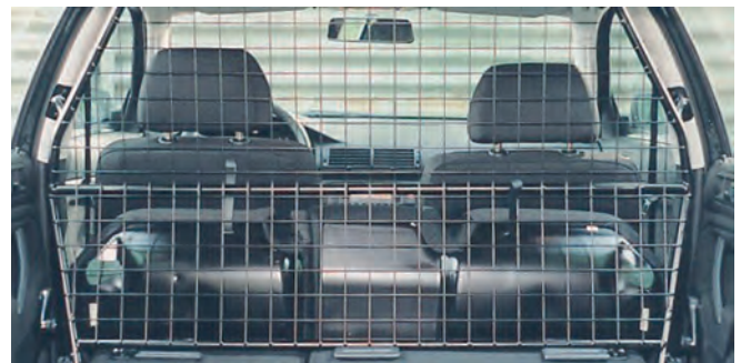
Nachträglich eingebautes Trenngitter nach DIN 75410-2
