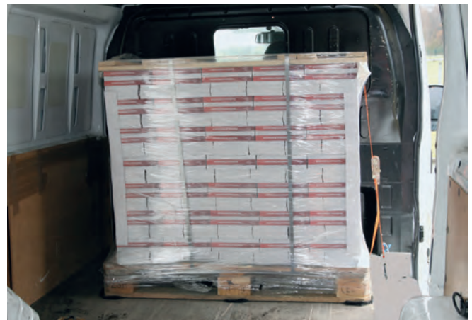
Ansicht von hinten: Der Zurrurt verläuft etwa im Winkel von 90°, wodurch annähernd die gesamte Vorspannkraft des Zurrmittels in das Ladegut eingeleitet wird. Da die Bücherpalette einer ordnungsgemäßen transportfähigen Ladeeinheit entspricht, ist die Ladungssicherung entsprechend der technischen Normen möglich.
