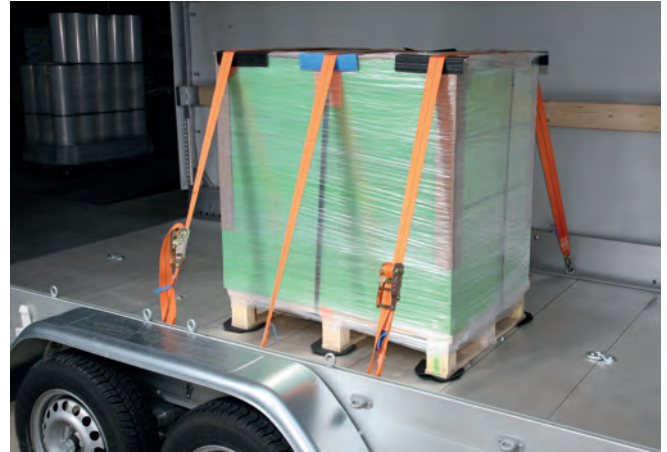
Durch Niederzurren gesicherte Palette auf einem Anhänger; die Ratschen wurden wechselseitig angeordnet.
