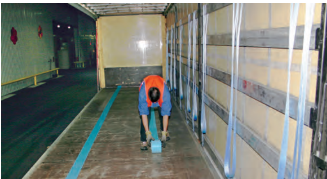
Ausrollen des rutschhemmenden Materials
