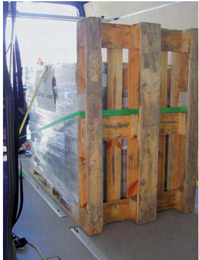
oben: Sicherung nach vorne durch Kopfschlinge mittels Zurrkord und Palette
