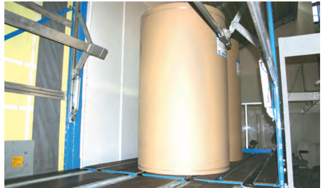
Die Rollen werden außerhalb des Fahrzeugs auf einer Verladebühne bereitgestellt und das Transportfahrzeug an diese Station „angedockt“.
