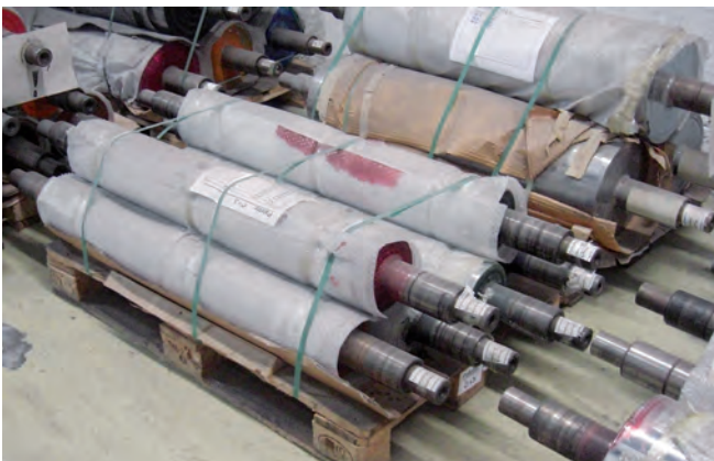
links: Nicht ausreichend stabile Ladeinheit. Die Kunststoffbänder sind nicht ausreichend stabil und die mittlere Rolle liegt lose. Bei einer Vollbremsung rutscht die Walze heraus und führt zu einer Gefährdung. Es sind geeignete Gestelle oder Kisten zu verwenden.
