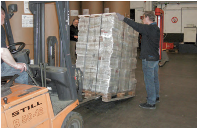
Erfolgreicher Kippversuch (V6, Gewicht 704 kg); Palette bei 33° gekippt; Ladeeinheitensicherung geeignet
