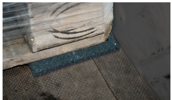
Seitenansicht: Einsatz von Anti-Rutsch-Matten zur Verbesserung des Reibbeiwertes: Ein Überstand des rutschhemmenden Materials ist notwendig, damit eine Ladung auch dann, wenn sie einmal ankippen sollte, keinen Kontakt zur Ladefläche bekommt.
