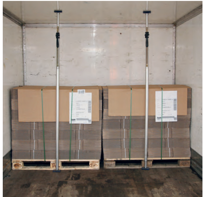
Klemmstangen zum rückwärtigen Fixieren gegen Kippen
