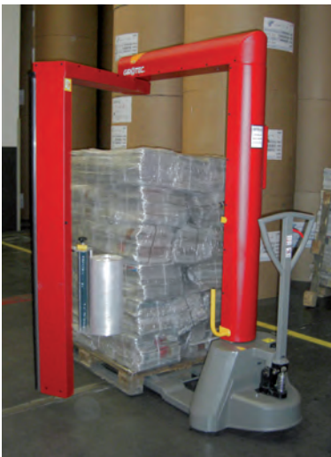
Mobiler, netzunabhängiger Hubwagen-Dreharmwickler
