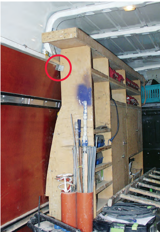
Dieses selbst gebaute Holzregal ist ungenügend am Fahrzeugaufbau befestigt (rote Markierung). Generell ist von solchen „Eigenbauten“ abzusehen.
