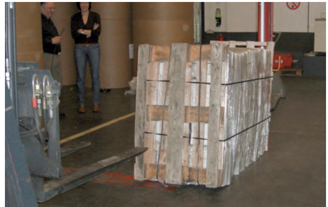
Erfolgreicher Kippversuch (V6, Gewicht 704 kg); Palette bei 33° gekippt; Ladeeinheitensicherung geeignet
