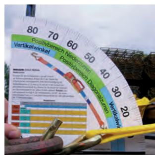
Hier verbleiben von der Kraft der Ratsche nur noch etwa 17 % zur Ladungssicherung.
