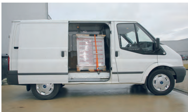
Seitenansicht: Bücherpalette formschlüssig an der Stirnwand und gemäß Lastverteilungsplan positioniert
