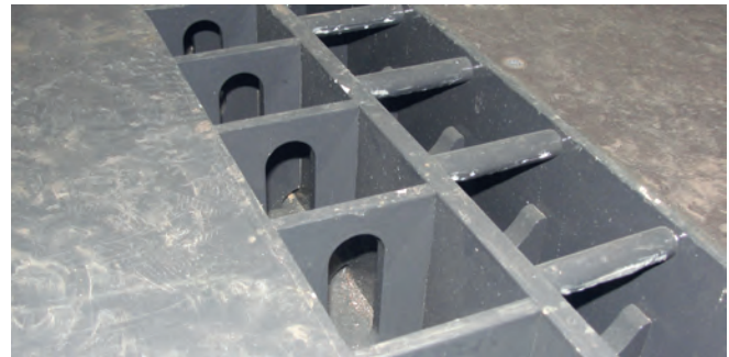
Rungentaschenreihe mit Zurrloch; Belastung Zurrlöcher 2.000 daN
