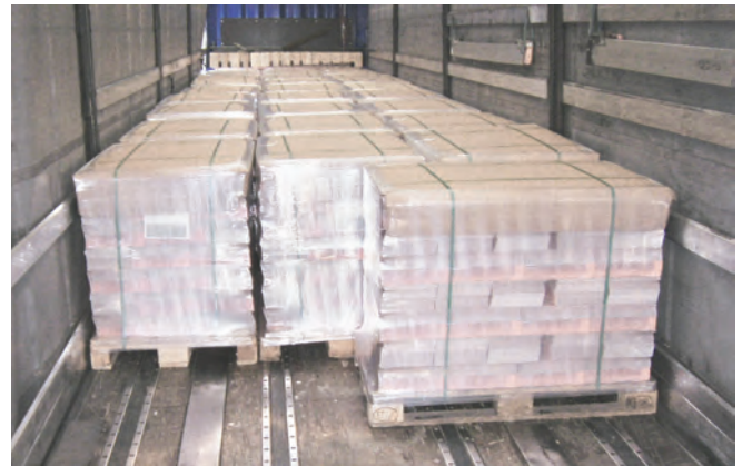
Kombination: Stülphaube aus Pappe, Umreifung, horizontale Folienstretzung
