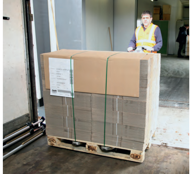
Auf ausreichende Beleuchtung der Ladefläche achten. Vor dem Einfahren die Befahrbarkeit der Ladefläche prüfen. Lkw durch Unterlegkeil gegen Wegrollen sichern.
