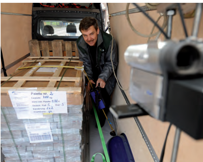
Installation der Mess- und Videotechnik
