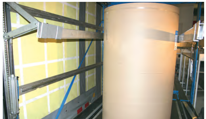
Die Rollen werden durch die seitlichen Klemmbalken fixiert.
