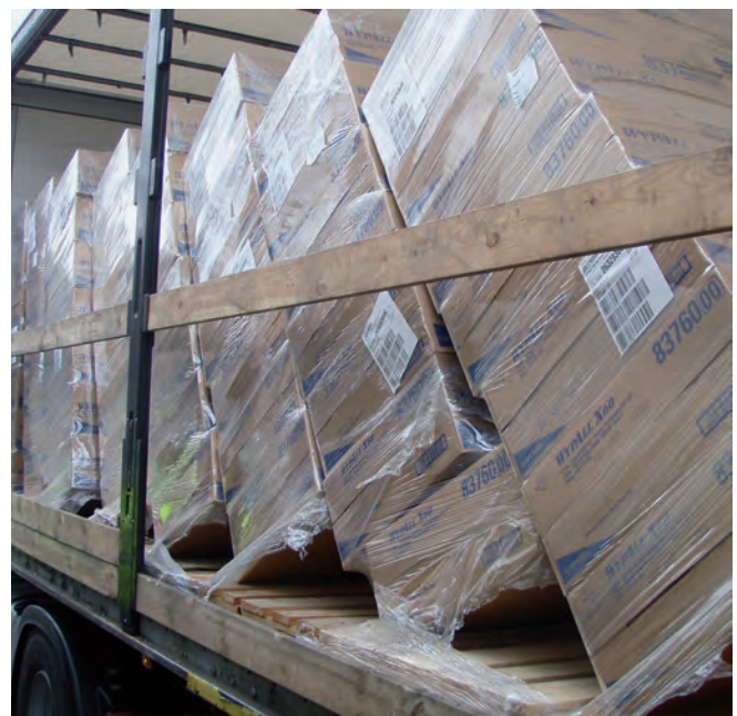
80 % des Ladungsgewichts wirken bei einer Gefahrenbremsung nach vorne.
