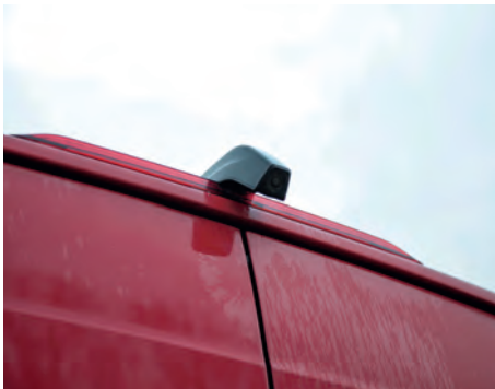
Rückfahrkamera zur Unterstützung beim Rangieren und Rückwärtsfahren.
