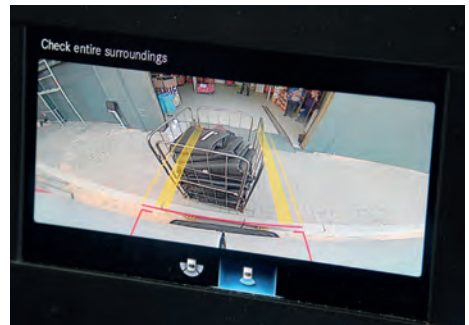
Rückfahrkamera für sicheres Rangieren und Rückwärtsfahren.
