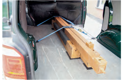
Niederzurren und Formschluss an Trennwand.
