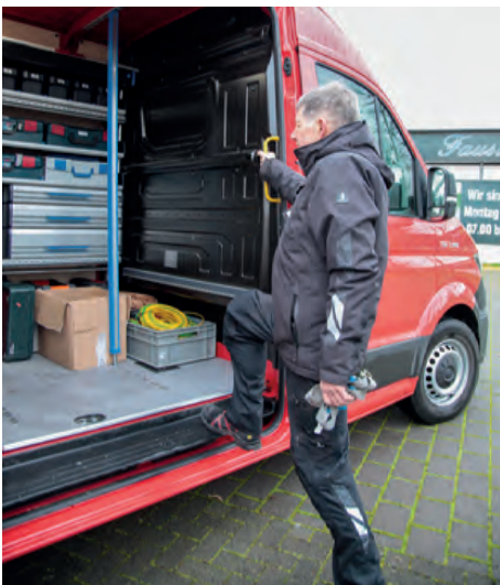
Stirnwand zum Schutz des Fahrpersonals und Handgriff zum sicheren Einsteigen in den Laderaum.
