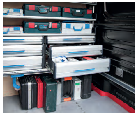
Schneller Zugriff auf Arbeitsmaterialien in Schub-laden; Werkzeugkoffer mit Klemmvorrichtung formschlüssig gesichert.
