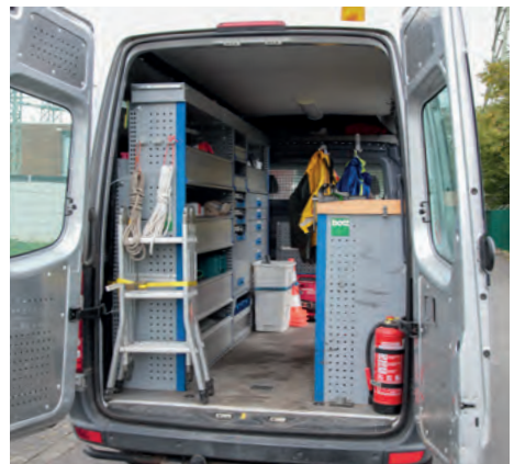
Multifunktionsleiter und Feuerlöscher mit Zurr- gurten gesichert.
