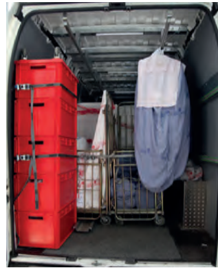
Kunststoffkisten und Wäscherollcontainer formschlüssig verladen und mit Klemmgurten an Seitenwand gesichert. Kleiderschutzhüllen an Kleiderstangen.
