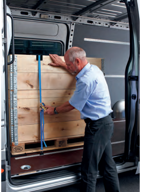
Formschluss durch Anlegen an Stirnwand. Lastverteilungsplan beachten!
