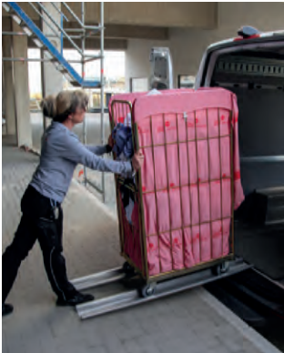
Verladeschienen für den Transport von Wäscherollcontainern.
