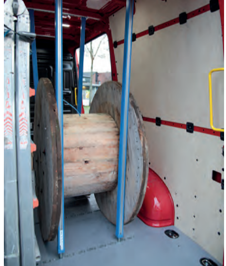
Kabeltrommeln mit Sperrstangen gesichert.
