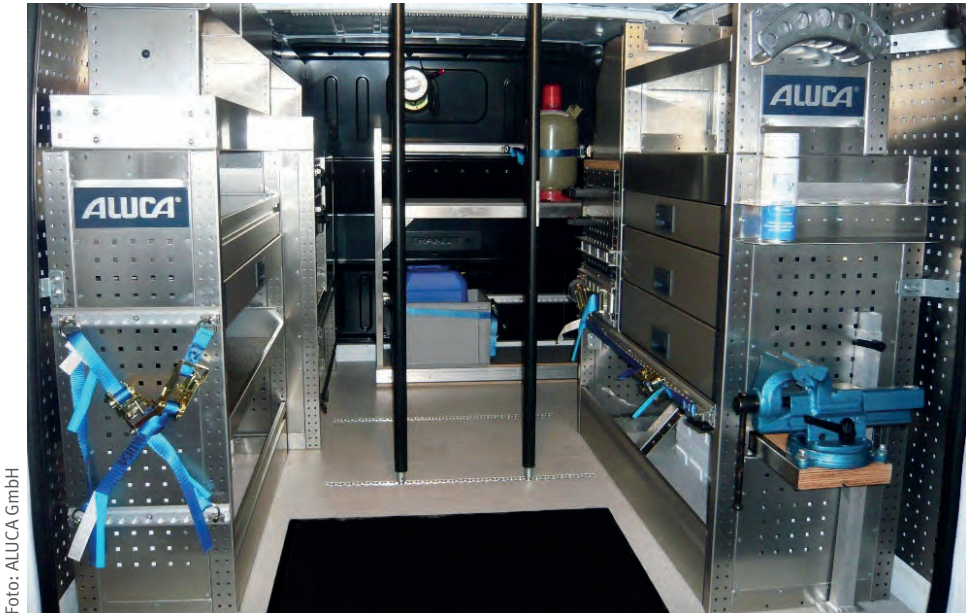
Herstellung von Formschluss durch senkrechte Sperstangen; Reibungserhöhung durch großflächige Anti-Rutsch-Matte.
