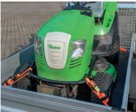
Aufsitzrasenmäher durch Diagonalschlingen mit vier Zurrgurten gesichert. Gang eingelegt und/oder Feststellbremse betätigt.
