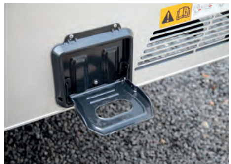
Klapptritt an Bordwand für sicheres Besteigen der Ladefläche.
