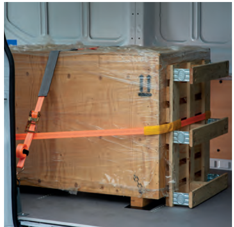
Kombinierte Ladungssicherung: Niederzurren und Kopfschlinge für die Sicherung in Fahrtrichtung.
