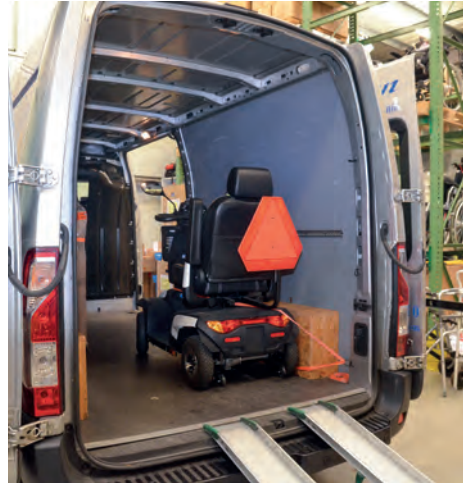
Sicherung mit Zurrgurten und Feststellbremse.
