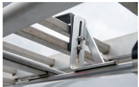
Anschläge sichern die Leitern in Fahrtrichtung. Zur Seite und nach hinten Sicherung durch Zurrgurte.
