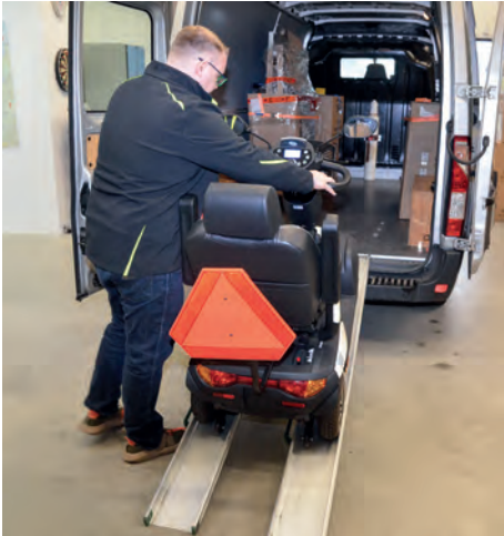
Verladung des Elektro-Krankenfahrstuhls mit Hilfe von Verladeschienen.
