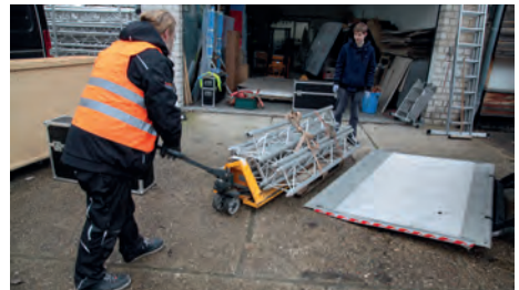
3-Punkt-Traversen auf Palette mit zwei Zurrgurten zur transportfähigen Ladeinheit gepackt.
