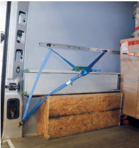
Verladeschienen mit Klemmschloss-Zurrgurt gesichert.
