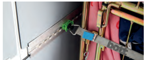
Airlineschiene mit mobilem Zurrpunkt an Seitenwand.
