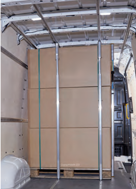
Formschluss durch Anlegen an Fahrzeugwand in Kombination mit senkrechten Sperrstangen.
