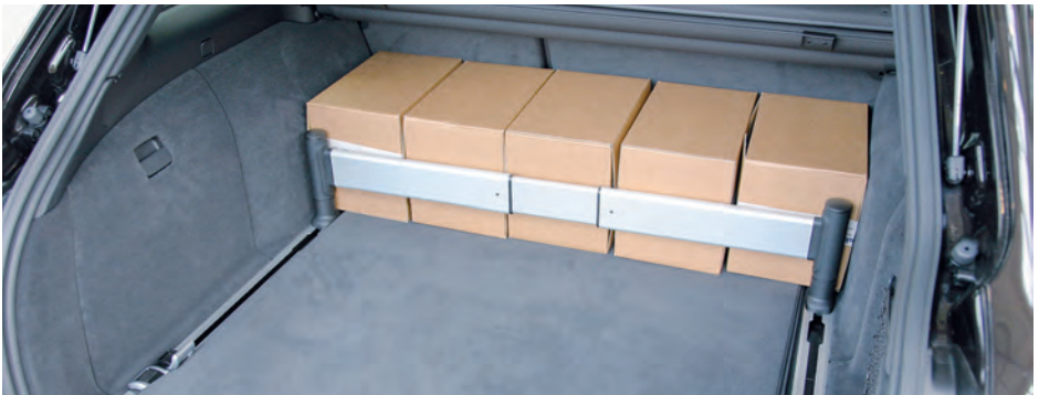
Schienensystem im Gepäckraum für Teleskopstangen.
