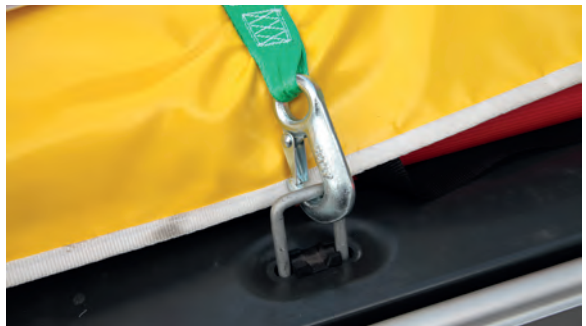
Nützliches Detail am Zurrhaken: Hakensicherung verhindert Herausrutschen aus Zurröse.
