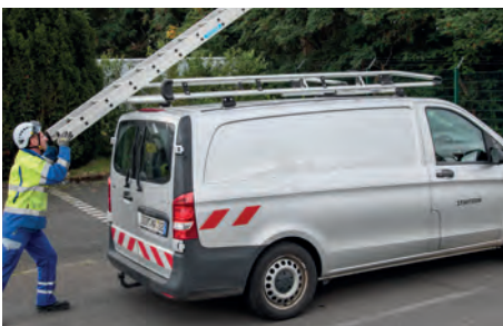
Servicefahrzeug mit Leiterträger. Laufrolle erleichtert das Aufschieben der Leiter.
