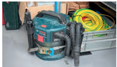
Nass-/Trockensauger und Transportkiste mit Zurr-gurt gesichert.
