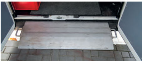
Sicherer geht es kaum! Mobiles Ladeblech für den Zugang zum Laderaum.
