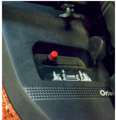
Elektro-Scooter: Feststellbremse als zusätzliche Transportsicherung betätigen.
