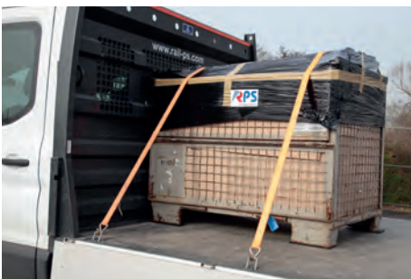
Kombinierte Ladungssicherung: Anlegen an die Stirnwand, Niederzurren sowie Anti-Rutsch-Matten.
