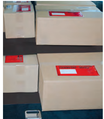
Ladungssicherung mit einem Trennnetz und Anti-Rutsch-Matten. Die Kräfte in Fahrtrichtung werden durch die umgeklappte Rücksitzbank und das Trennnetz aufgenommen; zu den Seiten durch die Karosserie und nach hinten durch die Heckklappe. In diesem Beispiel ist der Formschluss nach hinten nur bedingt möglich, daher sollte die Ladelücke bis zur Heckklappe ausgefüllt oder rutschhemmendes Material eingesetzt werden.
