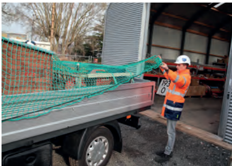
Zusätzliche Sicherheit durch Abdecknetz.
