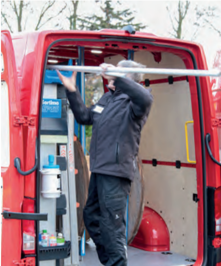
Links und oben: Praktisch – Langgutwanne für Leerrohre und Stangenmaterial.
