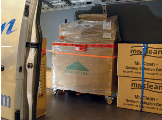
Von links nach rechts: Pflegebett auf Rollen gesichert mit Zurrurt an Seitenwand. Formschluss zur Stirnwand zweier Kartons mit Matratzen und gesichert mit Zurrurt.
