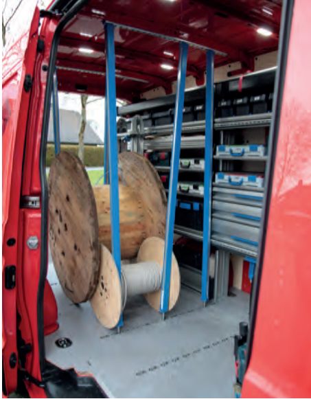
Kabeltrommeln mit Sperrstangen gesichert.
