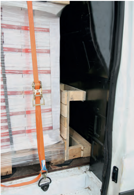
Niederzurren und Formschluss zur Stirnwand: Ausfüllen der Ladelücke mit Palette und Holzbalken.
