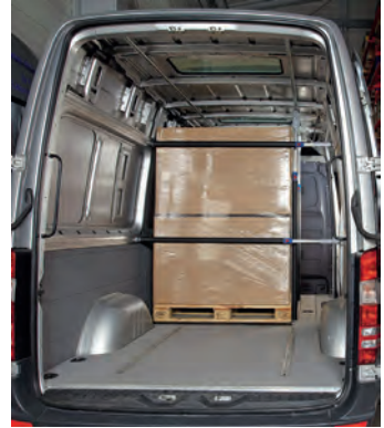
Airlineschienen mit horizontalen Sperrstangen im Transporter
