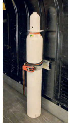
Sauerstoffflasche mit Haltevorrichtung an Stirnwand.
