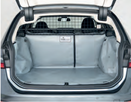
Trenngitter oberhalb der Rücksitzbank beim Pkw-Kombi sowie Kofferraumschutz.
