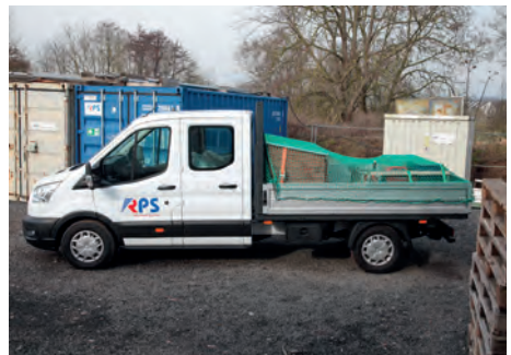
Abdecknetz verhindert ein Herabwehen leichter Teile während der Fahrt.
