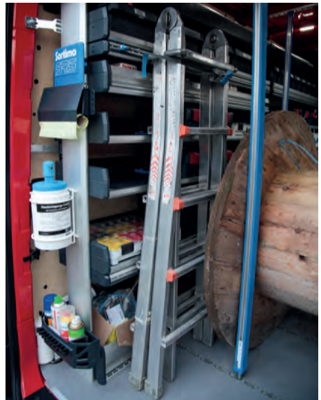
Kabeltrommeln mit Sperrstangen gesichert.
