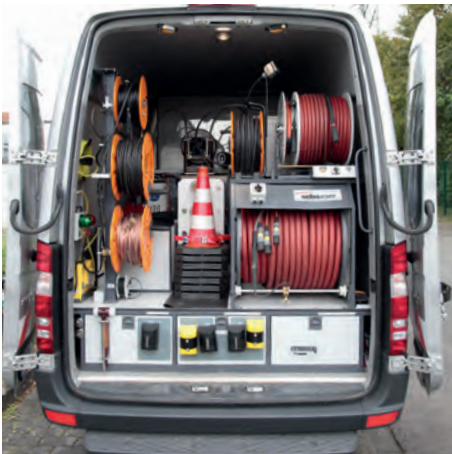
Kabel- und Messtrommeln mit dem Fahrzeug-aufbau fest verbunden.
