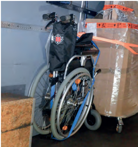
Rollstuhl an Seitenwand verzurt; Zurrpunkte am Boden und an Seitenwand (Airlineschiene).
