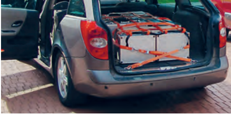
Zurrnetz für Pkw-Kombi und Mehrzweck-Pkw
