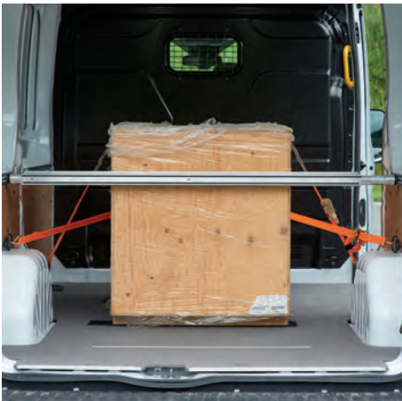
Formschlüssige Sicherung nach hinten mit einem Sperrbalken.
