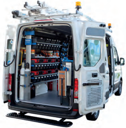
Regaleinbauten, Sicherung von Gasflaschen.
