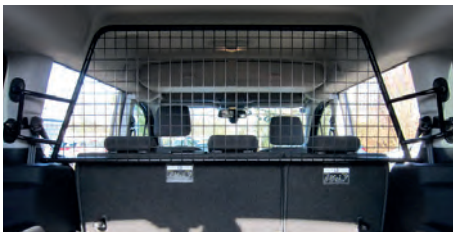
Nachträglich eingebautes Trenngitter.
