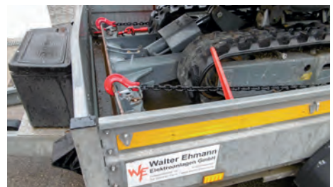
Kleinbagger vom Hersteller mit geeigneten Zurrpunkten ausgerüstet. Hakensicherung des Zurrhakens geschlossen.
