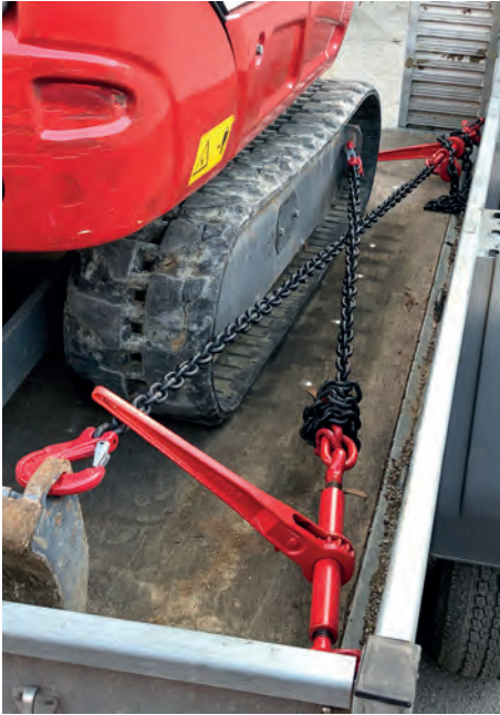
Diagonalschlingen: Vier Zurrketten in Zurrpunkten am Gerät und Anhänger eingehakt und leicht vorgespannt.
