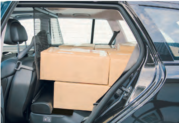
Ladungssicherung mit einem Trennnetz und Anti-Rutsch-Matten. Die Kräfte in Fahrtrichtung werden durch die umgeklappte Rücksitzbank und das Trennnetz aufgenommen; zu den Seiten durch die Karosserie und nach hinten durch die Heckklappe. In diesem Beispiel ist der Formschluss nach hinten nur bedingt möglich, daher sollte die Ladelücke bis zur Heckklappe ausgefüllt oder rutschhemmendes Material eingesetzt werden.
