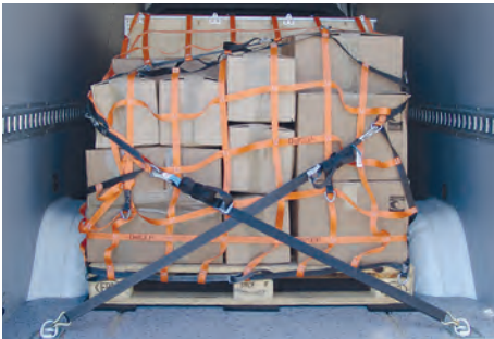
Zurrnetz für Transporter bestehend aus Netz und Schnellspanngurten
