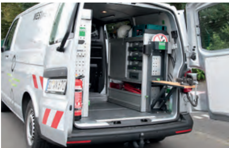
Regalsystem mit Auszügen, ausklappbarer Schraubstock.
