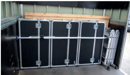
Ladung formschlüssig an Stirnwall sowie mit Anti-Rutsch-Matten und Klemmstange gesichert.
