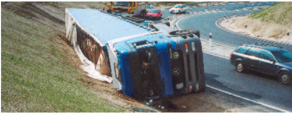
In der Linkskurve rutschte die Ladung nach außen. Dadurch stürzte der Sattelzug auf die rechte Fahrzeugseite.
