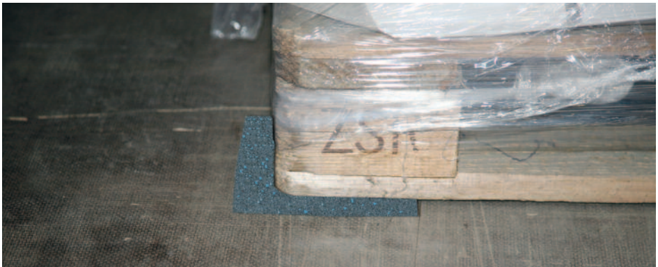
Anti-Rutsch-Matten zur Verbesserung des Reibbeiwertes
