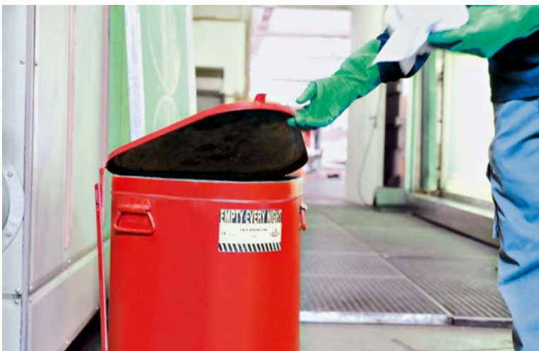
Gut geeigneter Behälter für gebrauchte Putzlappen: Bleicheimer mit Deckel.
