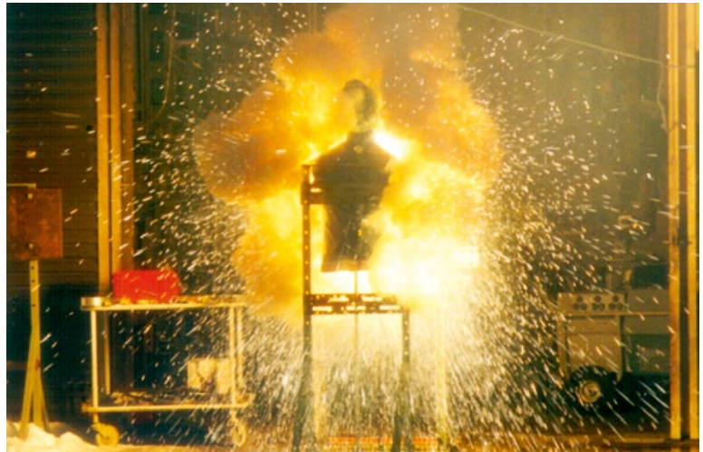
Ein Störlichtbogen kann zu schweren Verbrennungen mit lebensbedrohlichen Folgen führen, wie hier ein Dummy-Test zeigt.
