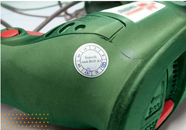
Prüfplakette auf einem elektrischen Betriebsmittel (Handbohrmaschine)
