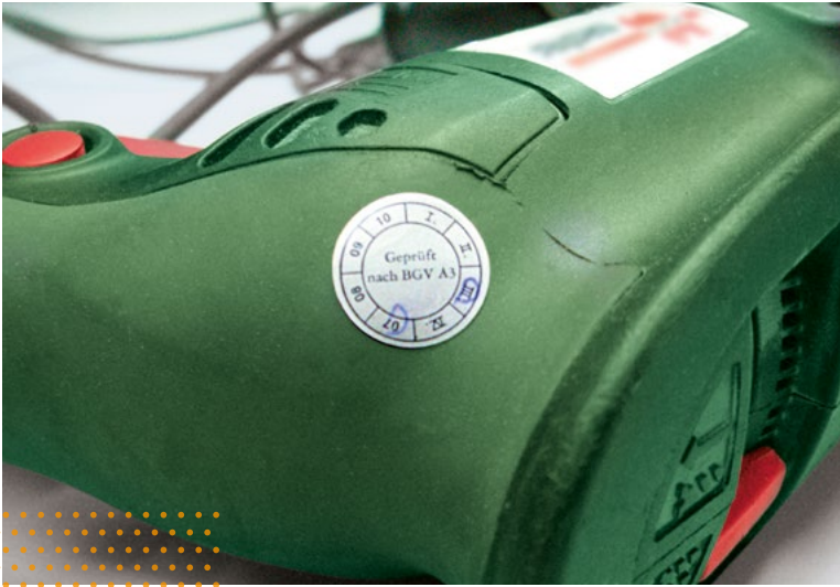
Prüfplakette auf einem elektrischen Betriebsmittel (Handbohrmaschine).
