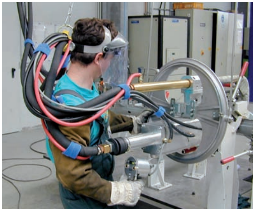
Bild 22: Beispiel für ungünstige Kabelführung
