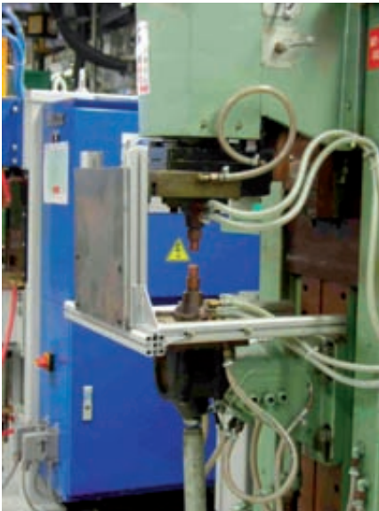
Bild 21a: Versuchsanordnung; vor dem Schweißfenster angebrachtes Schirmblech
