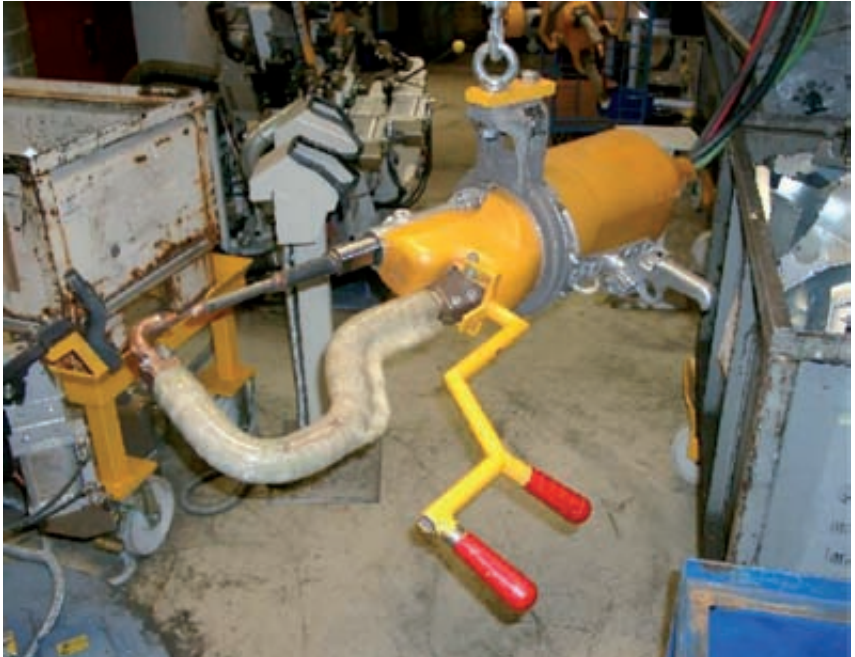
Bild 20: Trafozange mit Griffen
