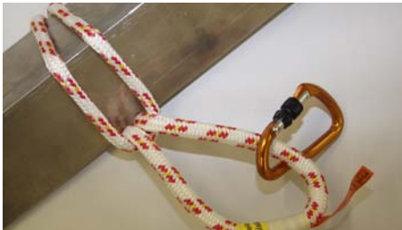
Abb. 35 Seilschleife zur Schaffung eines Anschlagpunktes.
