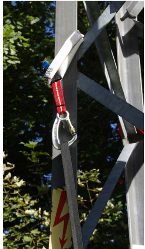
Abb. 37 Beispiel einer speziellen Bandschleife für erhöhte Belastungen. Im Belastungsfall können Band- und Seilschleifen durch Scherkräfte in Konstruktionsteilen übermäßig belastet werden. Es empfiehlt sich ein Einsatz speziell für diese Verwendung ausgewiesener Schlaufen.
