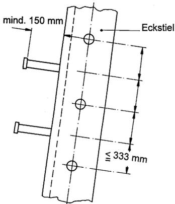
Bild 8: Zweiläufiger Steigbolzengang an Freileitungsmast-Eckstiel
