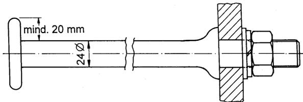
Bild 1: Beispiel für **Steigbolzen mit Scheibe**
