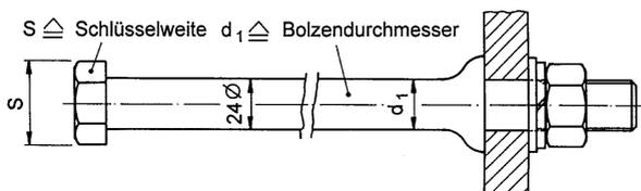
Bild 3: Beispiel für **Steigbolzen mit Sechskantkopf**
