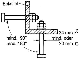
Bild 6: Zweiläufiger Steigbolzengang an Freileitungsmast-Eckstiel
