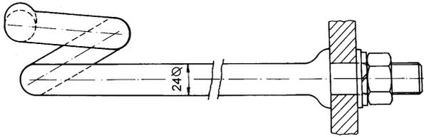
Bild 4: Beispiel für **Steigbolzen mit Sicherheitseinrichtung**
