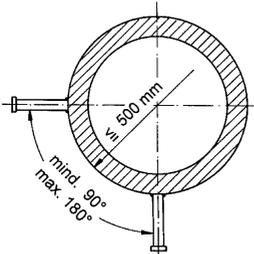
Bild 7: Zweiläufiger Steigbolzengang an Stahlrohrmasten
