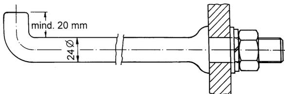
Bild 2: Beispiel für **Steigbolzen mit Abkröpfung**
