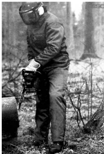
Abb. 15: Beispiel einer Schnittschutzhose nach DIN EN 381-5
