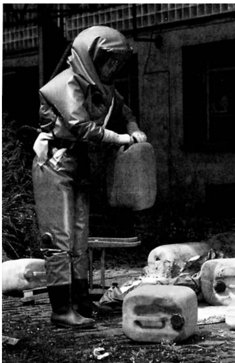
Abb. 7: Beispiel für einen Kontaminationsschutzanzug (unbelüftet, mit Atemschutz)
