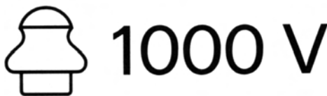
Bild 7: Kennzeichnung von elektrisch isolierenden Schuhen für Arbeiten an Niederspannungsanlagen
