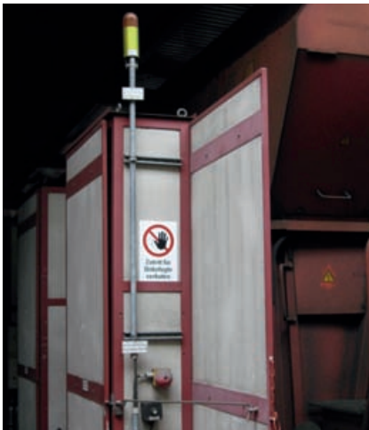
Abb. 12.3.1 Beispiel einer Auftauanlage mit gasbetriebenen Bodenbrennern sowie elektrisch betriebenen seitlichen Heizstrahlern
