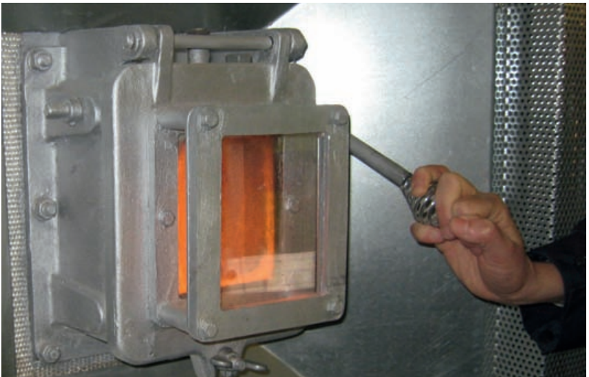
Abb. 10.3 Schauluke mit Sicherheitsverglasung
