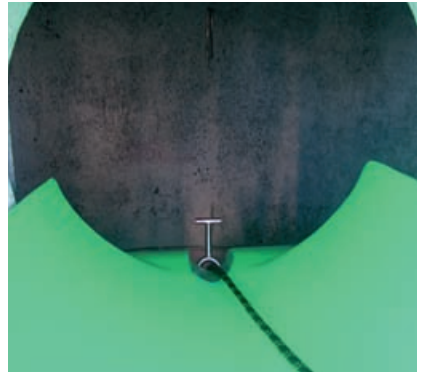
Abb. 15.1.1 Beispiel für den Einsatz einer Rettungsrutsche zum Retten einer Person durch eine seitlich eingebaute Einsteigöffnung eines Anlageteils [siehe auch Information „Retten aus Behältern, Silos und engen Räumen“ (BGI 5028)]
