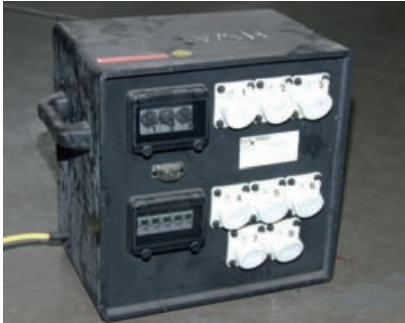
Abb. 9.2.1 Beispiel für einen Schutzklein- spannungsverteiler zum Ein- satz in leitfähigen Bereichen mit begrenzter Bewegungs- freiheit
