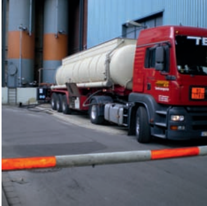
Abb. 12.4.1.1 Entladesituation mit LKW und Absperrung des Entladebereiches
