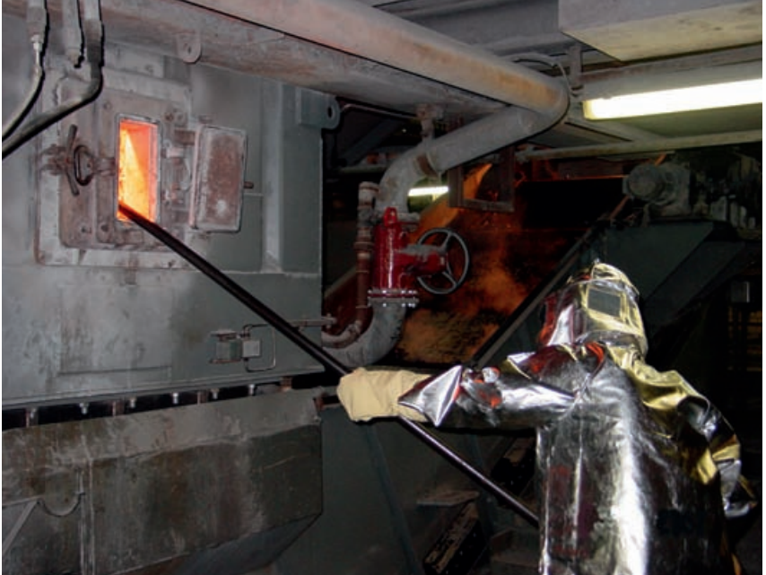
Abb. 4.4.1.2 Stocherarbeiten an einem A-Loch; Als PSA haben sich bewährt: Flammenschutzkopfhaube nach DIN EN 1486, Schutzhandschuhe gegen thermische Risiken nach DIN EN 407 und Kleidung zum Schutz gegen Hitze und Flammen (DIN EN ISO 11612).
