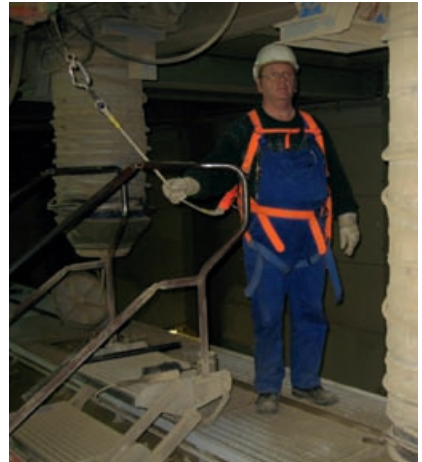
Abb. 12.1.3.2 Das Schienensystem gestattet den Einsatz einer PSA gegen Absturz. Ein gesichertes Begehen des gesamten Silo-waggons ist möglich.
