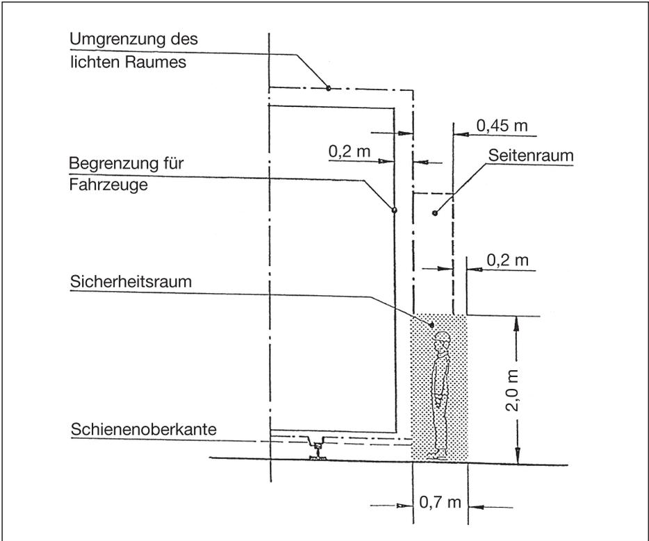
zu § 5 Abs. 2: Sicherheitsraum bei Straßenbahnen, die den Bestimmungen der Straßenbahn-Bau- und Betriebsordnung (BOStrab) unterliegen.
