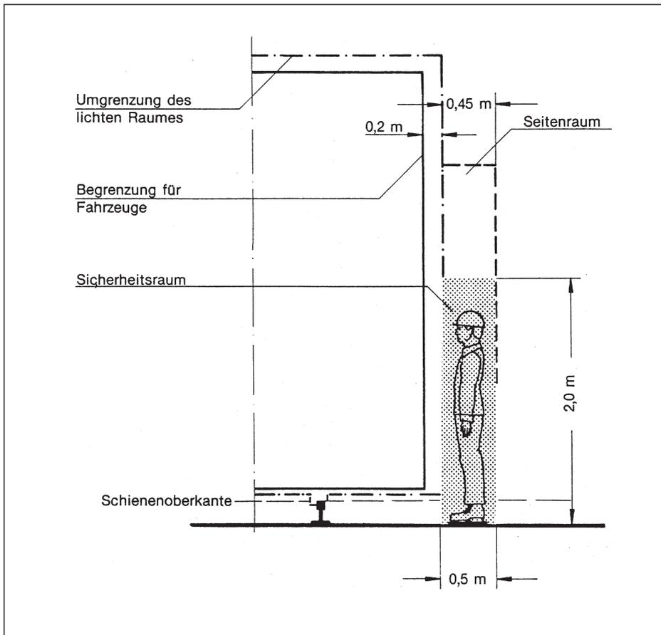
zu § 5 Abs. 2: Sicherheitsraum bei Eisenbahnen, die den Bestimmungen der Eisenbahn-Bau- und Betriebsordnung für Schmalspurbahnen (ESBO) unterliegen; bei Fahrgeschwindigkeiten über 30 km/h und bis 100 km/h.
