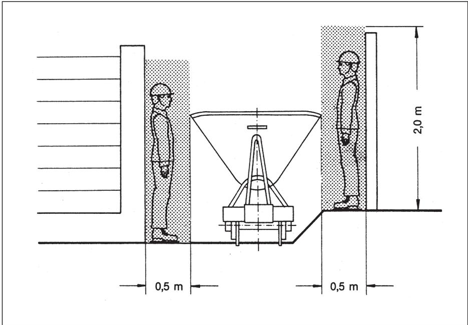
zu § 15 Abs. 2: Freizuhaltende Räume an den Fahrzeugenden von Eisenbahnen, die den Bestimmungen der Eisenbahn-Bau- und Betriebsordnung (EBO) oder der Eisenbahn-Bau- und Betriebsordnung für Anschlussbahnen (EBOA) unterliegen.
