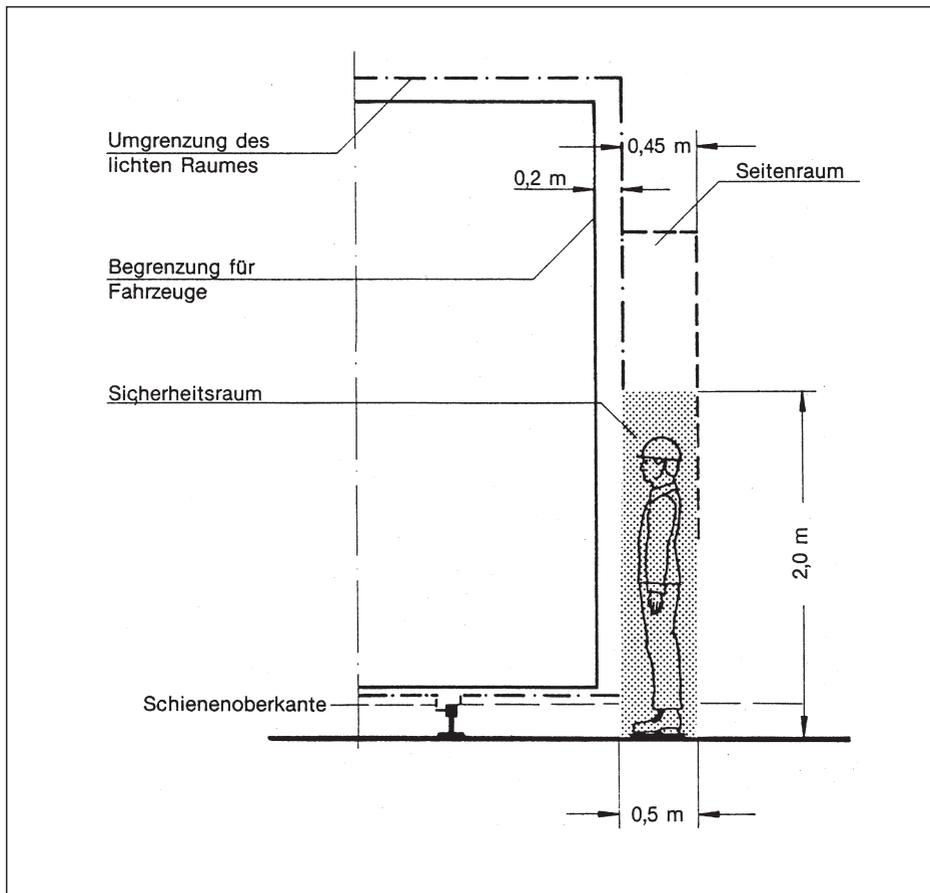
zu § 6 Abs. 1: Seitlicher Sicherheitsabstand (in Arbeitsstätten) bei Straßenbahnen, die den Bestimmungen der Straßenbahn-Bau- und Betriebsordnung (BOStrab) unterliegen.
