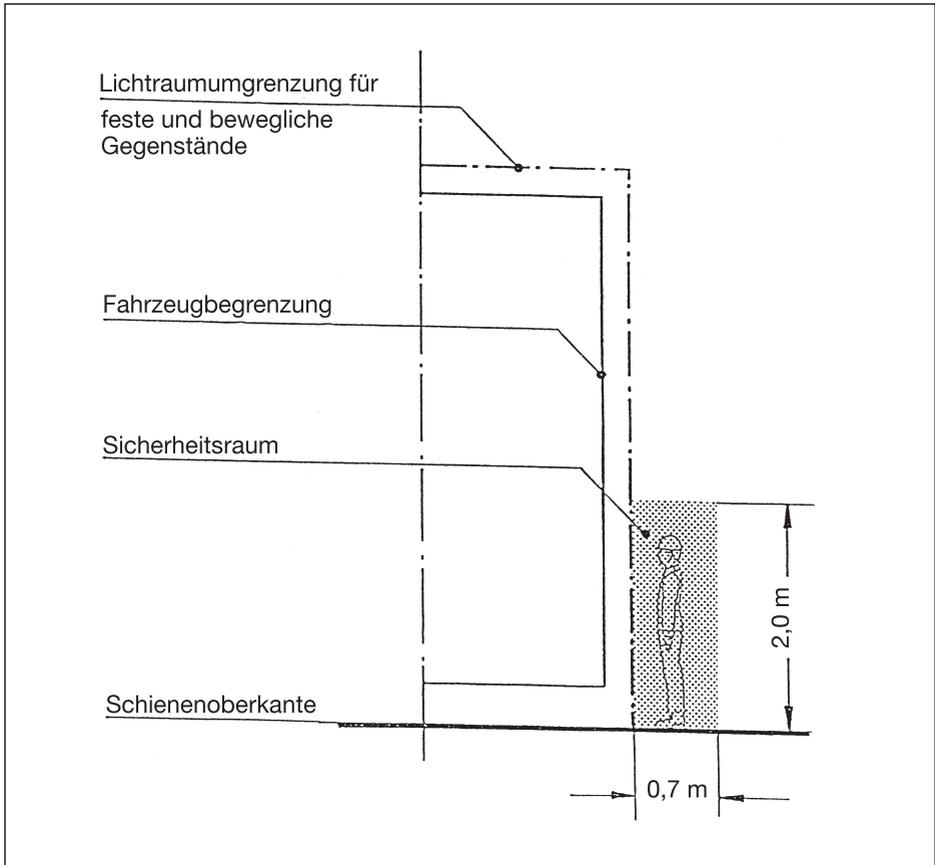
zu § 5 Abs. 5: Behelfsmäßiger Sicherheitsraum bei Straßenbahnen, die den Bestimmungen der Straßenbahn-Bau- und Betriebsordnung (BOStrab) unterliegen.
