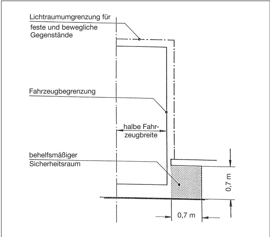
**zu § 6 Abs. 1:** Seitlicher Sicherheitsabstand (in Arbeitsstätten) bei Eisenbahnen, die den Bestimmungen der Eisenbahn-Bau- und Betriebsordnungen des Bundes und der Länder (EBO/EBOA/BOA) unterliegen; in der Geraden, für Versicherte, die sich im Gleis aufhalten.
