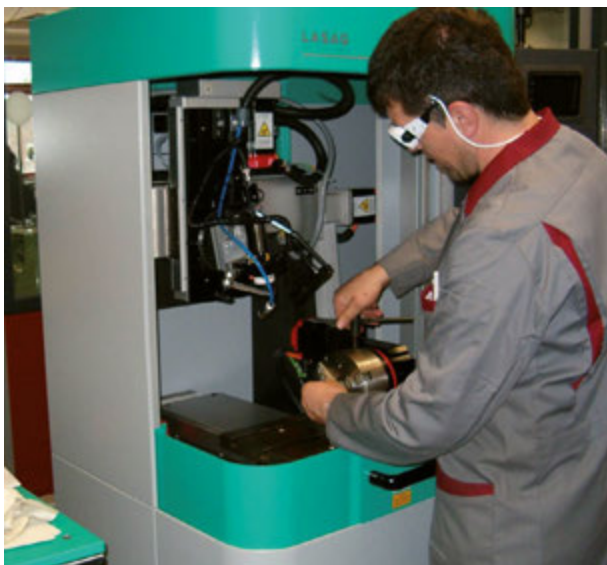
Bei offenem Laser – z. B. Einrichtungsarbeiten – muss eine Schutzbrille getragen werden. Schutzbrillen müssen der DIN EN 207 entsprechen.
