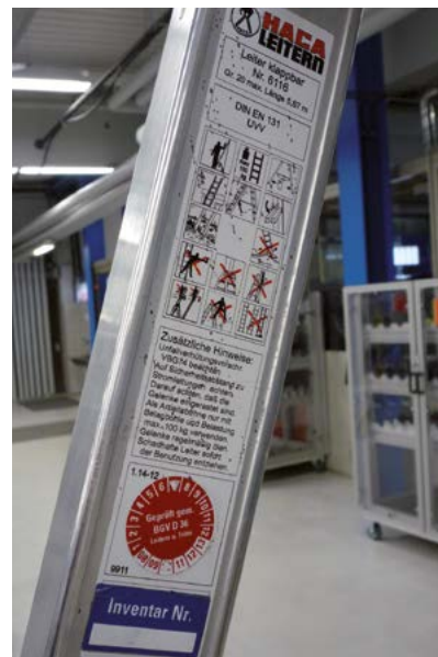
Betriebsanleitung und Prüfaufkleber auf einer Anlegeleiter. Beide Aufkleber erhalten Sie kostenlos von der Berufsgenossenschaft.
