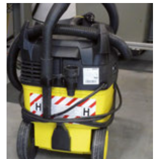
Schleifstäube nicht zusammenkehren, sondern mit einem Staubsauger der Staubklasse „M“ oder „H“ aufsaugen.
