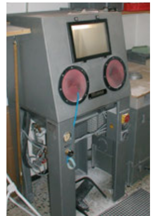
Regelmäßiges Tauschen der Dichtungen an der Handstrahlkabine vermeidet Verunreinigungen des Arbeitsraumes.
