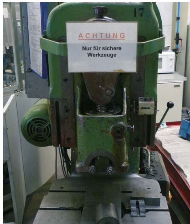
Diese ältere Presse verfügt über keine sichere Steuerung und darf deshalb nur noch mit sicheren Werkzeugen betrieben werden.
