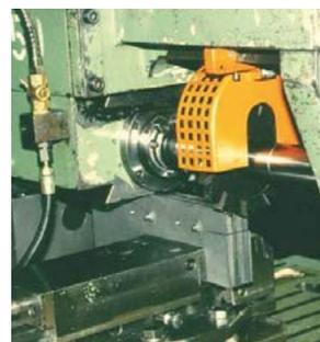
Fräferschutz an einer Horizontalfräsmaschine. Um keine neuen Gefahren zu schaffen, ist auf eine einwandfreie Befestigung der Verdeckung zu achten.
