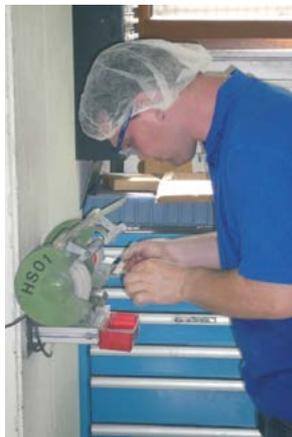
Eine gute Lösung ist die Integration von schlagfesten Sichtscheiben in die Schutzhaube. Der Schleifer steht mit dem Körper geschützt hinter der Sichtscheibe und umgreift diese mit beiden Händen.
