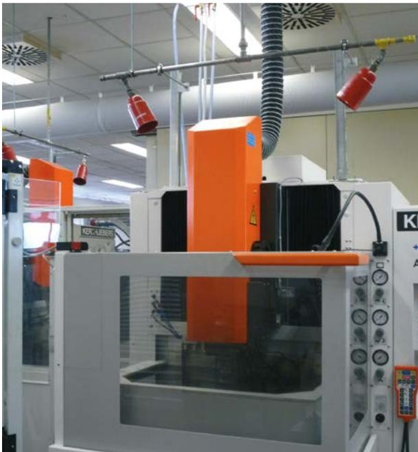
Absaugung und automatische C02-Löschanlage an einer Funkenerodiermaschine.
