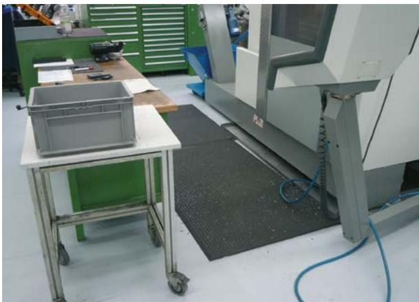
An diesem Arbeitsplatz ist der Standplatz des Drehers mit einer „Ergonomischen Steharbeitsplatzmatte“ zur Reduzierung der Belastung des Stütz- und Bewegungssystems ausgestattet. Die Werkzeuge stehen gut geordnet und griffbereit, die Verkehrs- und Bereitstellflächen sind ausreichend bemessen. Die sehr gute Beleuchtung und die Farbkombination prägen das positive Erscheinungsbild.
