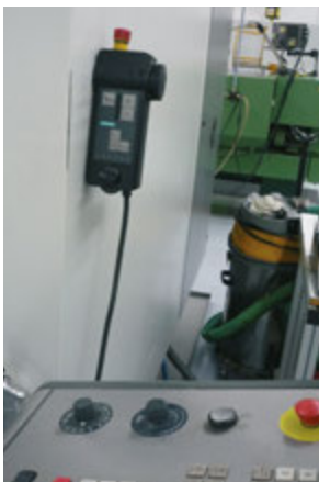
NC-Steuerung mit zusätzlichem Handbediengerät
