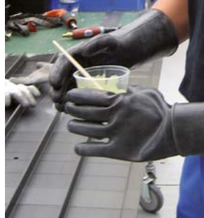
Vorbildhaft trägt der Mitarbeiter beim Anrühren von Epoxidharz Chemikalien-Schutzhandschuhe.
