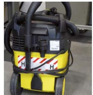
Schleifstäube nicht zusammenkehren, sondern mit einem Staubsauger der Staubklasse „M“ oder „H“ aufsaugen.
