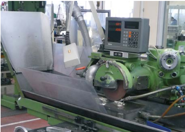
Flachschleifmaschine mit Spritzwasserschutz
