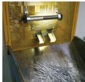
Feste Verdeckung mit Lochblech an der Rückseite der Presse. Somit kann auch von hinten niemand in den Pressenraum eingreifen.
