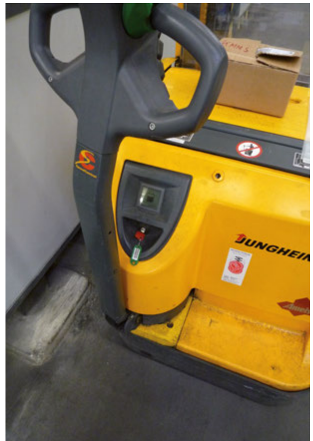
Mitgänger-Flurförderzeuge werden in den Betrieben häufig „Ameise“ genannt. Beim Abstellen der „Ameise“ ist immer der Schlüssel abzuziehen, damit sie nicht unbefugt benutzt werden kann.
