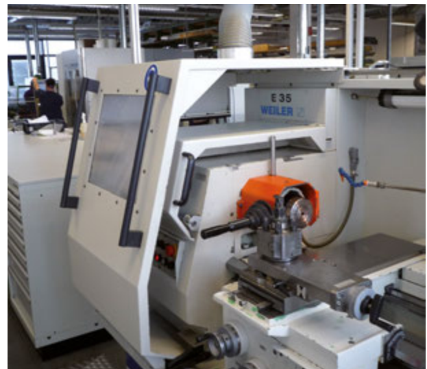
Hier ist die Absaugung in die verschiebbare Verdeckung integriert.
