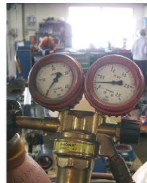
Gasflaschen immer gegen Umfallen sichern, z. B. mit Ketten, Bügeln oder Lagerung in Flaschenwagen. Zum Schicht- oder Arbeitsende das Absperrventil an der Flasche zudrehen, damit aus eventuell undichten Stellen an Manometer, Schlauch oder Brennerventil kein Gas austritt.
