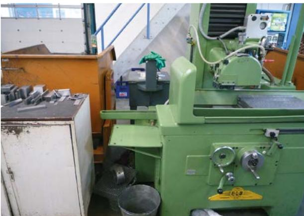
**Gefährlich:** Hier ist die Flachschleifmaschine so aufgestellt, dass bei bewegtem Schleifmaschinentisch eine Quetschstelle zwischen Maschine und Schrank entsteht.
