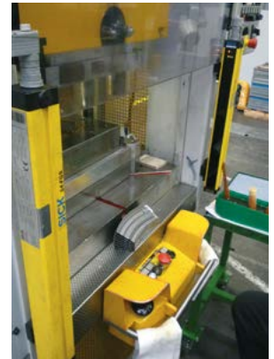
Presse mit BWS (Lichtschranke). Wahlweise kann die Presse auch mit Zweihandschaltung betrieben werden.
