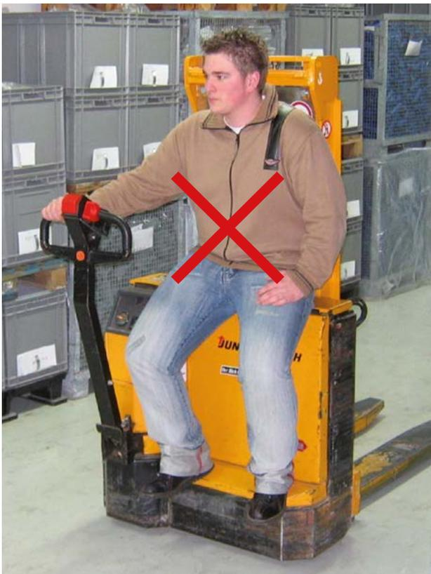
**Achtung:** Wegen extremer Unfall- und Verletzungsgefahr ist das Mitfahren auf dem Flurförderzeug verboten. Setzen Sie dieses Verbot rigoros durch!
