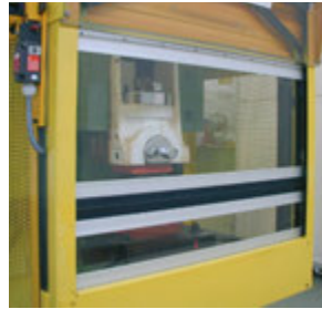
Bewegliche Verdeckung an der Pressenvorderseite
