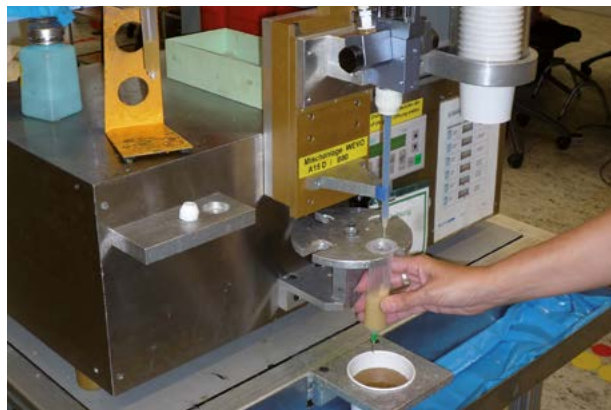
Durch eine Vergussanlage wird Hautkontakt weitgehend vermieden; wenn nicht, sind die ausgelegten Nitril-Handschuhe zu benutzen.
