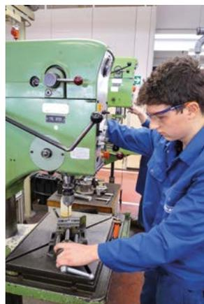
Vorschriftsmäßiges, sicheres Arbeiten mit Schutzbrille und eingespanntem Werkstück.
