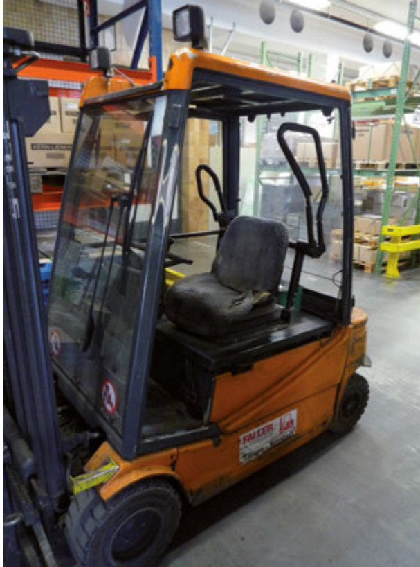
Gabelstapler mit Fahrerschutzdach und seitlichen Schutzbügeln. Der Gabelstapler kann nur fahren, wenn der Schutzbügel heruntergeklappt und damit geschlossen ist.
