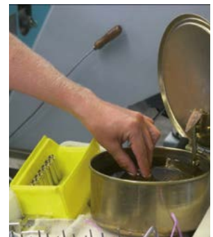
Falsch und gesundheitsgefährdend: Der Dreher taucht die Teile nach der Bearbeitung per Hand in Kaltreiniger.
