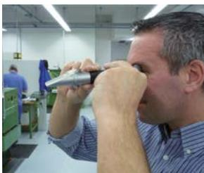
Konzentrationsbestimmung mit dem Refraktometer
