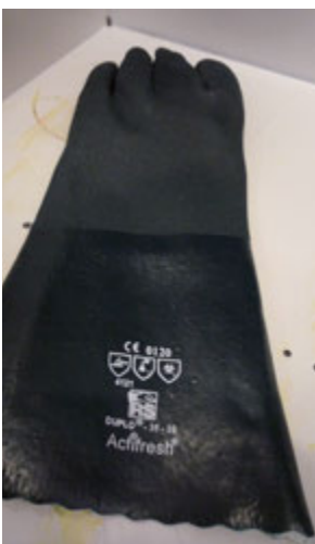
Schutzhandschuhe gegen chemische Gefahren müssen mit dem entsprechenden Piktogramm gekennzeichnet sein.
