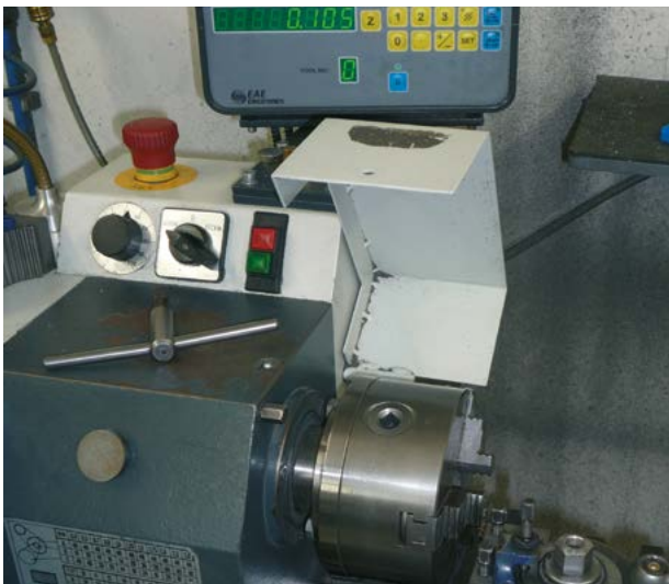
Klappbarer Backenfutterschutz ist heutzutage das gesetzliche Minimum an Drehmaschinen.
