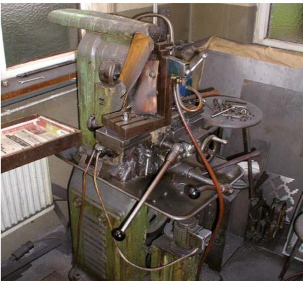
Durch eine regelmäßige elektrische Prüfung werden Beschädigungen erkannt. Hier muss umgehend die Zuleitung erneuert werden.
