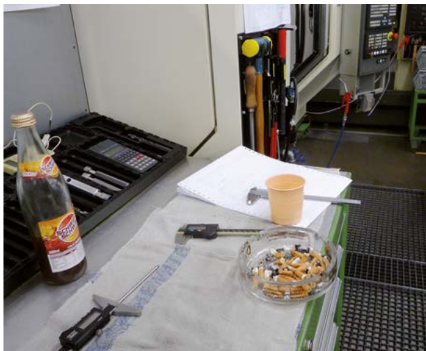
Beim Umgang mit Kühlschmierstoffen dürfen die Mitarbeiter wegen der Gefahrstoff-Problematik nicht rauchen und nicht aus offenen Behältnissen (z. B. Kaffeebecher) trinken.
