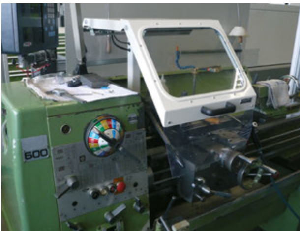
Komfortabler ist eine nachgerüstete klappbare Schutzhaube, die mit der Maschinensteuerung verriegelt ist.
