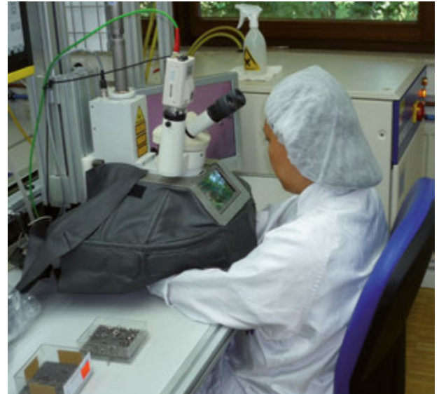
Besserer Schutz gegen Laserstrahlung, da geschlossene Einhausung mit Durchgriffsöffnung für die Hände
