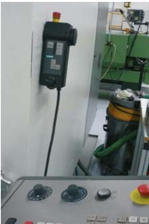
NC-Steuerung mit zusätzlichem Handbediengerät
