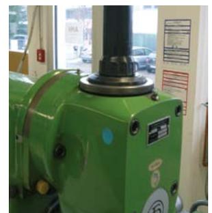
Nach der Einrichtung der Maschine muss das Ende der Fräerspindel immer abgedeckt werden.
