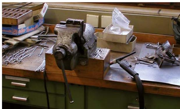
WIG-Schweißen ist ein häufig eingesetztes Schweißverfahren – hier bei der Herstellung chirurgischer Instrumente. Allerdings sind an diesem Arbeitsplatz die berufsgenossenschaftlichen Anforderungen z. B. im Hinblick auf den Brandschutz nicht erfüllt.
