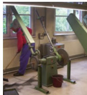
Schleifstäube nicht zusammenkehren, sondern mit einem Staubsauger der Staubklasse „M“ oder „H“ aufsaugen.
