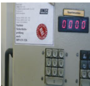
Der Prüfaufkleber gibt das Datum der nächsten Prüfung an.
