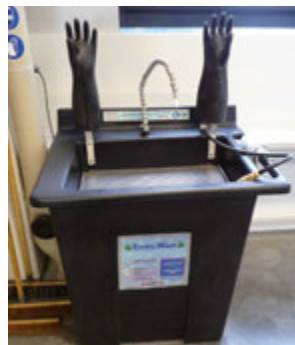
Auswaschplatz mit einem wässrigen Reiniger. Gut ist auch die Lösung für die Handschuhablage/-trocknung.
