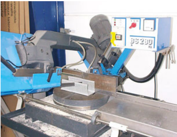
Das Sägeblatt ist bis auf den zum Sägen erforderlichen Bereich abgedeckt.
