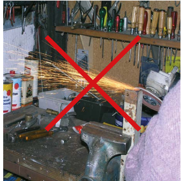
Brandgefährlich: „Heißarbeiten“ in der Nähe von brennbaren Lösungsmitteln; hier müssen Sie sofort einschreiten.
