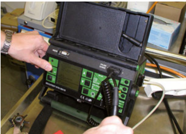
Prüfung der ortsveränderlichen elektrischen Betriebsmittel mit geeignetem Messgerät
