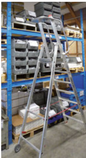
Bei Lagern für Handbedienung bieten Podest-Leitern eine sichere Aufstiegsmöglichkeit.
