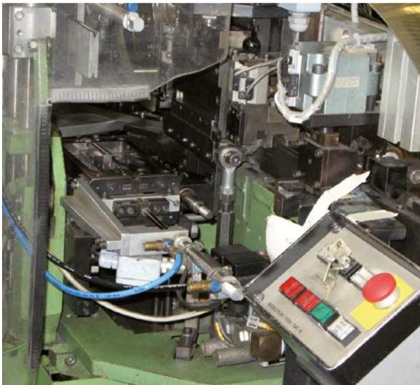
**So nicht!** Die Verkleidung des Montageautomaten ist ungenügend. Trotz Verkleidung sind noch Öffnungen vorhanden, durch die der Mitarbeiter in die laufende Maschine greifen kann.
