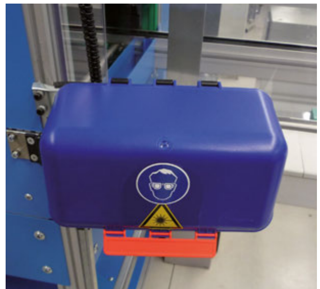
Sichere Aufbewahrung der Laserschutzbrille in einer Box
