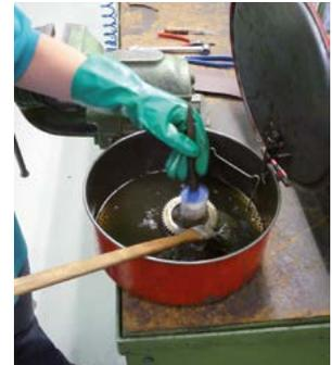
Behälter mit selbstschließendem Deckel
