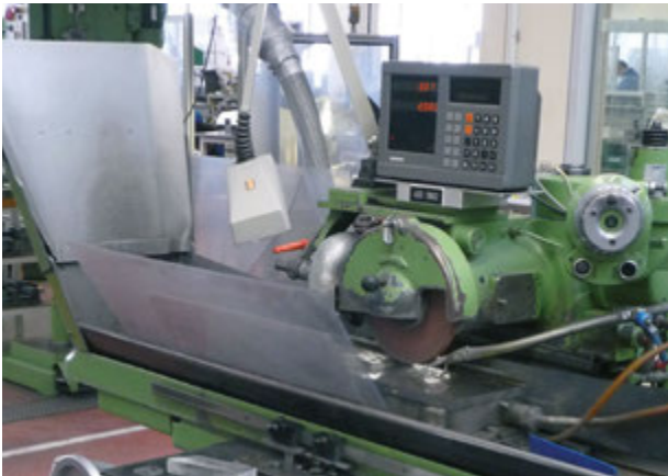
Flachschleifmaschine mit Spritzwasserschutz
