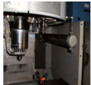
Absaugung im Bearbeitungsraum
