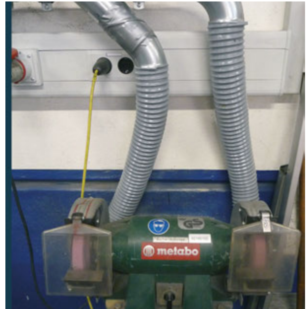
Werkstattschleifmaschine mit Absaugung und Sichtscheibe
