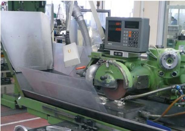
Flachschleifmaschine mit Spritzwasserschutz
