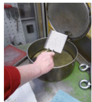
Besser: Mit Hilfe eines Siebes wird der Handkontakt mit dem Kaltreiniger weitgehend vermieden.
