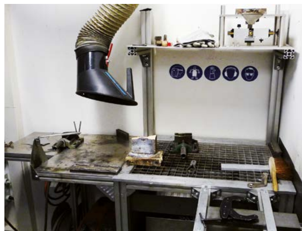
Schweißarbeitsplatz mit nachführbarer Absaugung
