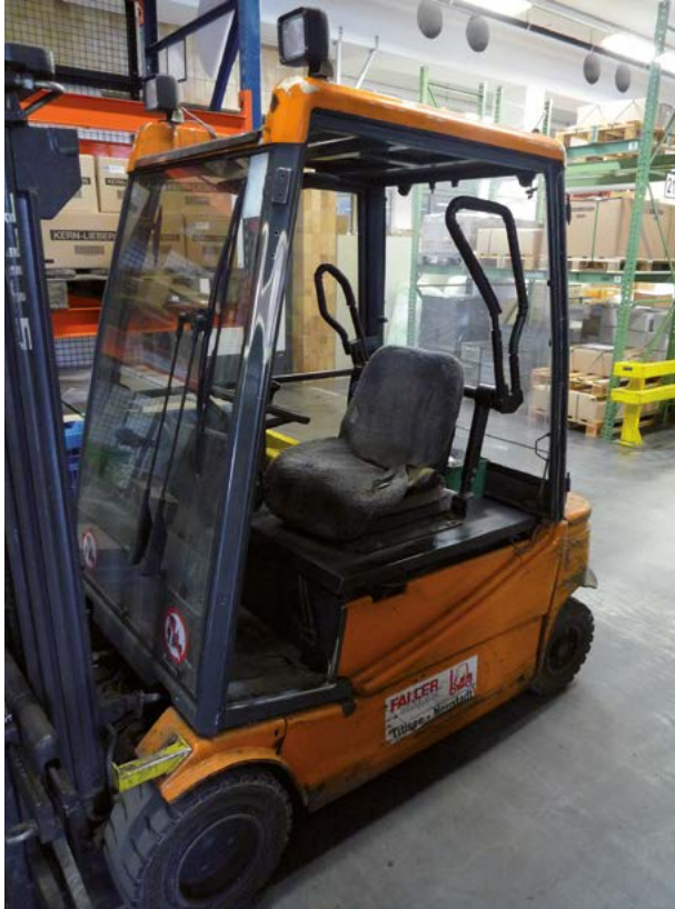
Gabelstapler mit Fahrerschutzdach und seitlichen Schutzbügeln. Der Gabelstapler kann nur fahren, wenn der Schutzbügel heruntergeklappt und damit geschlossen ist.
