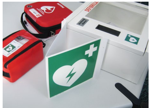
Automatisierter Externer Defibrillator (AED)
