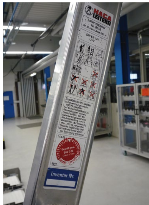
Betriebsanleitung und Prüfaufkleber an einer Anlegeleiter
