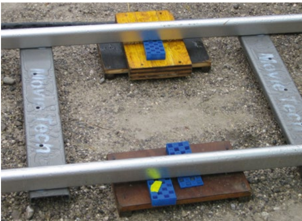
Schienen für einen Kamerakran
