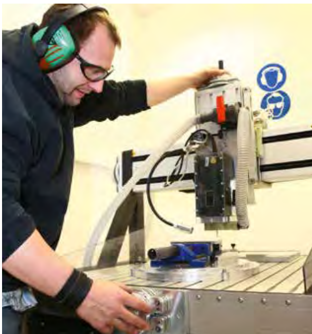
Vorschriftsmäßiges, sicheres Arbeiten mit Schutzbrille und eingespanntem Werkstück.
