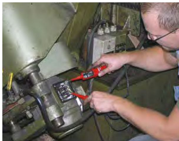
An der Arbeitsstelle immer erst die Spannungsfreiheit prüfen und sichern.
