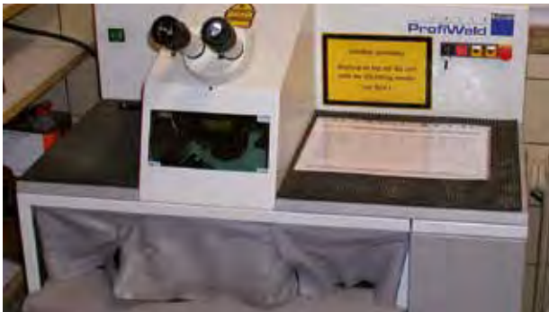
Einfacher Schutz gegen Laserstrahlung
