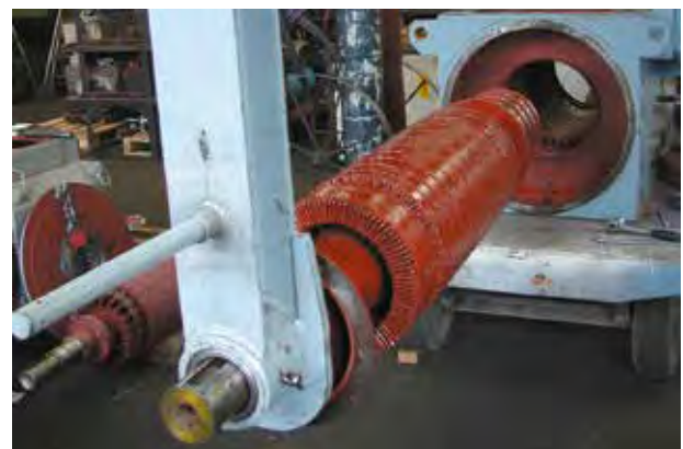
Eine spezielle Traverse als Anschlagmittel für den sicheren und exakt steuerbaren Transport eines Kollektors.
