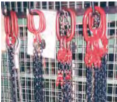
Vorbildlich geordnetes Kettengehänge mit Belastungstabellen.
