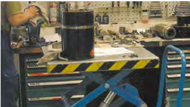
Technische Hilfsmittel wie dieser Hubtisch sind letztlich billiger als die Arbeitsunfähigkeitstage eines Mitarbeiters. Bei den Elektroberufen sind Erkrankungen des Muskel-Skelett-Systems der Grund für jede vierte Arbeitsunfähigkeitsdiagnose. Die AU dauert durchschnittlich 16 Tage.
