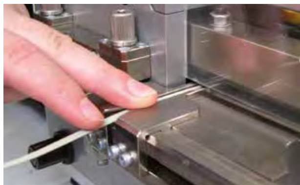
Die Crimpmaschine (links) und die Schneidmaschine (rechts) sind vorbildlich verkleidet. Der Finger kann die Quetsch- oder Schneidstelle niemals erreichen.
