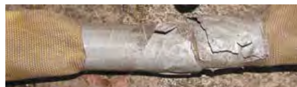
Ablegereif: Ummantelung und Einlage dieser Rundschlinge sind durch Schnitte stark beschädigt.
