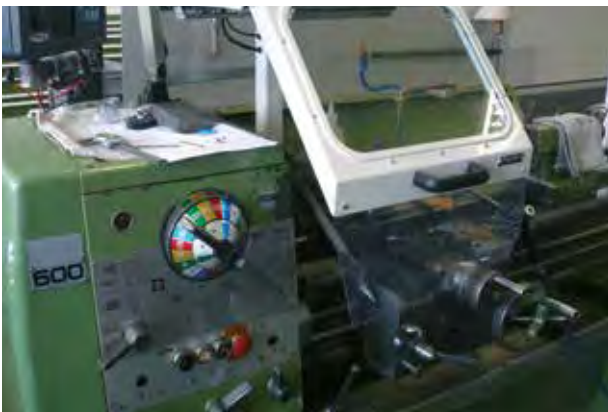
Komfortabler ist eine nachgerüstete klappbare Schutzhaube, die mit der Maschinensteuerung verriegelt ist.
