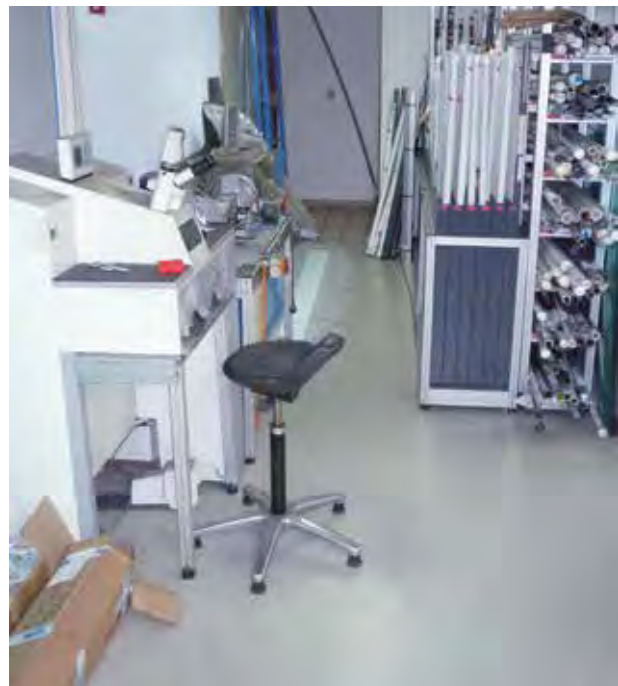
Hier wurde in unzulässigerweise ein provisorischer Arbeitsplatz im Verkehrsweg errichtet. Außerdem sind durch das auf dem Boden abgestellte Material Stolperstellen entstanden.
