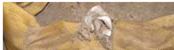
Ablegereif: Ummantelung und Einlage dieser Rundschlinge sind durch Schnitte stark beschädigt.
