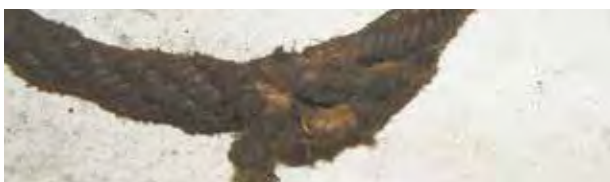
Eine zerstörte Litze, die das wichtige Fasermehl verliert.
