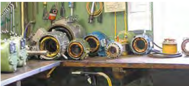
Beispielhafte Gewichte von Elektromotoren: 550 W = ca. 8 kg, 3 kW = ca. 18 kg, 15 kW = ca. 60 kg
