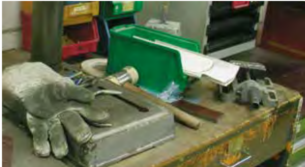
Handschuhe haben beim Arbeiten an der Bohrmaschine nichts zu suchen,
