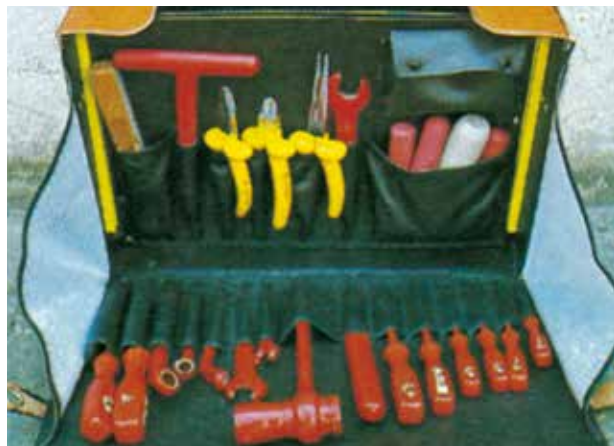
Werkzeugtasche mit isoliertem Werkzeug
