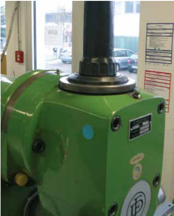
Nach der Einrichtung der Maschine muss das Ende der Fräterspindel immer abgedeckt werden.
