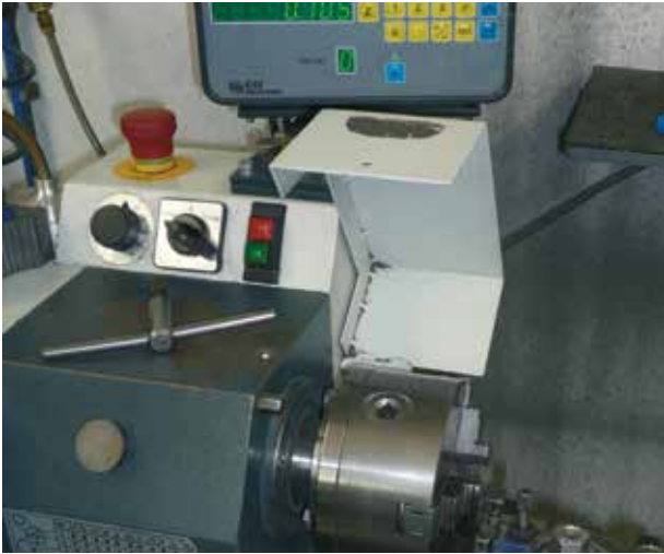
Klappbarer Backenfutterschutz ist heutzutage das gesetzliche Minimum an Drehmaschinen.
