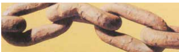
Kette mit verbogenem und eingekerbtem Kettenglied
