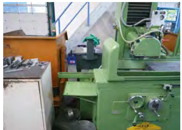
Werkstattschleifmaschine mit Absaugung und Sichtsscheibe
