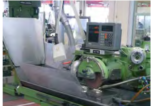
Flachschleifmaschine mit Spritzwasserschutz
