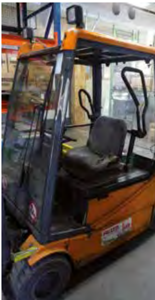
Gabelstapler mit Fahrerschutzdach und seitlichen Schutzbügeln. Der Gabelstapler kann nur fahren, wenn der Schutzbügel heruntergeklappt und damit geschlossen ist.
