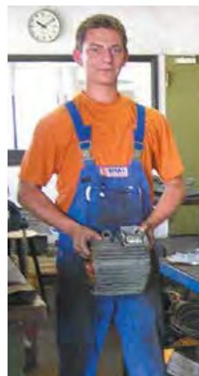
Eng am Körper und in gerader Haltung trägt dieser Monteur den Motor und bewahrt damit seine Bandscheiben vor starken Belastungen.
