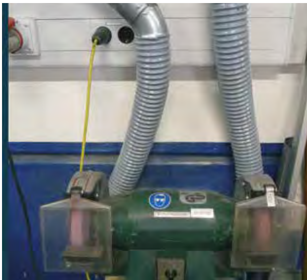
Werkstattschleifmaschine mit Absaugung und Sichtsscheibe
