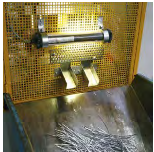
Bewegliche Verdeckung an der Pressenvorderseite
