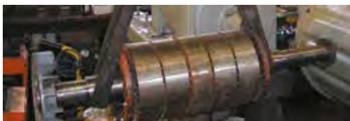
Hebebänder als Anschlagmittel im Elektromaschinenbau
