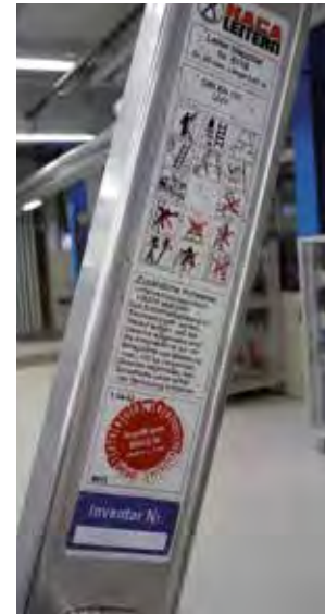
Betriebsanleitung und Prüfaufkleber auf einer An- legerleiter. Beide Aufkleber erhalten Sie kostenlos von der Berufsgenossenschaft.
