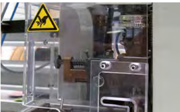
Die Crimpmaschine (links) und die Schneidmaschine (rechts) sind vorbildlich verkleidet. Der Finger kann die Quetsch- oder Schneidstelle niemals erreichen.
