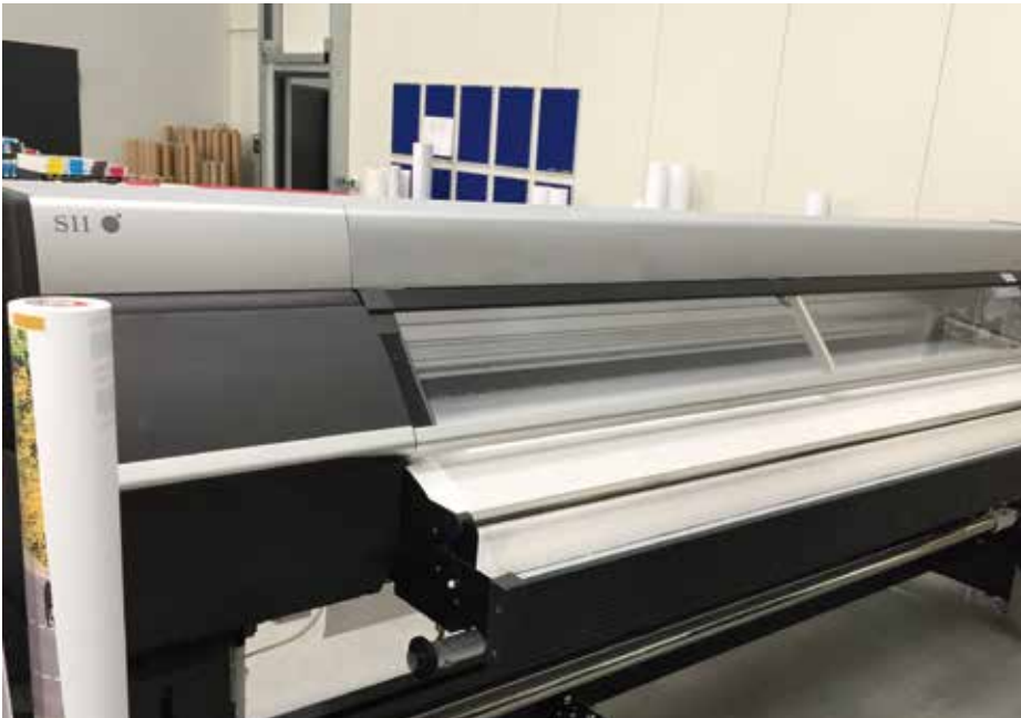
Trennende Schutzeinrichtung über dem Druckkopf
