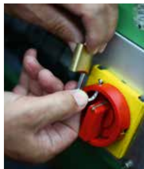
„Gegen Wiedereinschalten sichern“ heißt eine wichtige Sicherheitsregel bei Instandhaltungsarbeiten.
