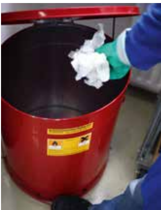
Geeigneter Behälter für Putztücher, die mit Ölen oder entzündlichen Reinigern durchtränkt sind.
