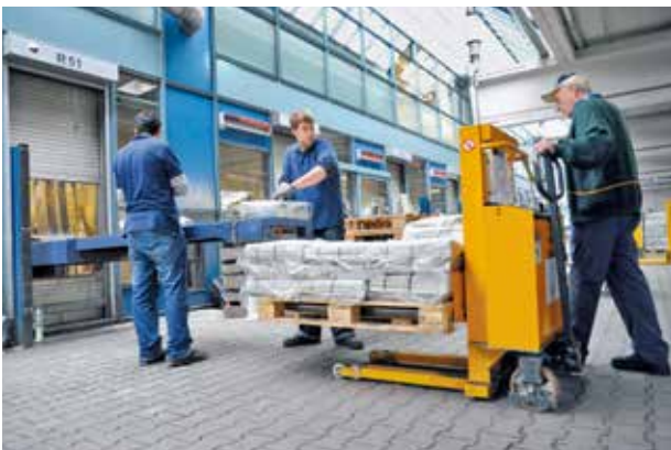
Stapelhilfen wie z. B. Hubtische ermöglichen ergonomisch richtige Arbeitshöhen zum Ab stapeln.
