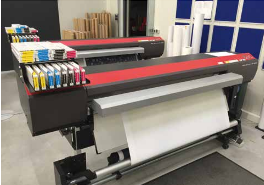
Aufwicklung mit Farbkartuschensystem
