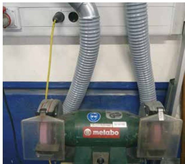
Werkstattschleifmaschine mit Absaugung und Sichtscheibe
