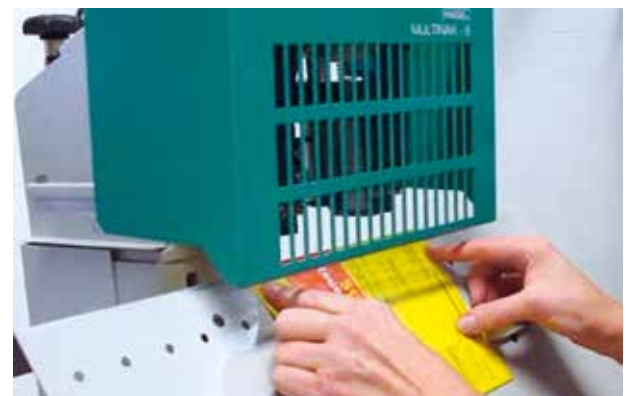
Sicherung der Gefahrstelle am Heftkopf durch eine einstellbare, trennende Schutzeinrichtung
