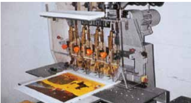
Großflächige, durchsichtige, trennende Schutzeinrichtung vor dem Gefahrenbereich an einer Heftmaschine
