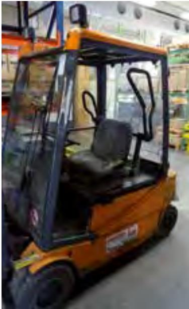
Gabelstapler mit Fahrerschutzdach und seitlichen Schutzbügeln. Der Gabelstapler kann nur fahren, wenn der Schutzbügel heruntergeklappt und damit geschlossen ist.
