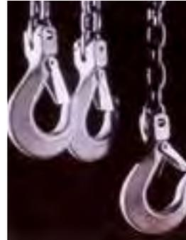
Die Kette links ist „abgelegt“. Die Maulöffnung des Hakens ist um mindestens 10% erweitert, die Klappe schließt nicht mehr.
