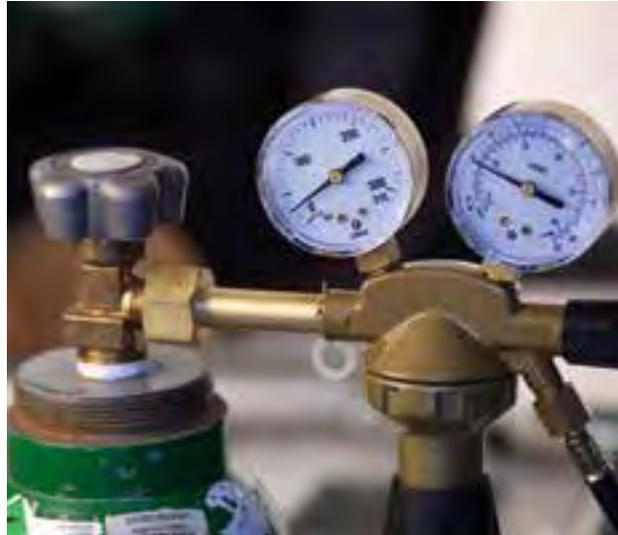
Gasflaschen immer gegen Umfallen sichern, z. B. mit Ketten, Bügeln oder Lagerung in Flaschenwagen. Zum Schicht- oder Arbeitsende das Absperrventil an der Flasche zudrehen, damit aus eventuell undichten Stellen an Manometer, Schlauch oder Brennerventil kein Gas austritt.
