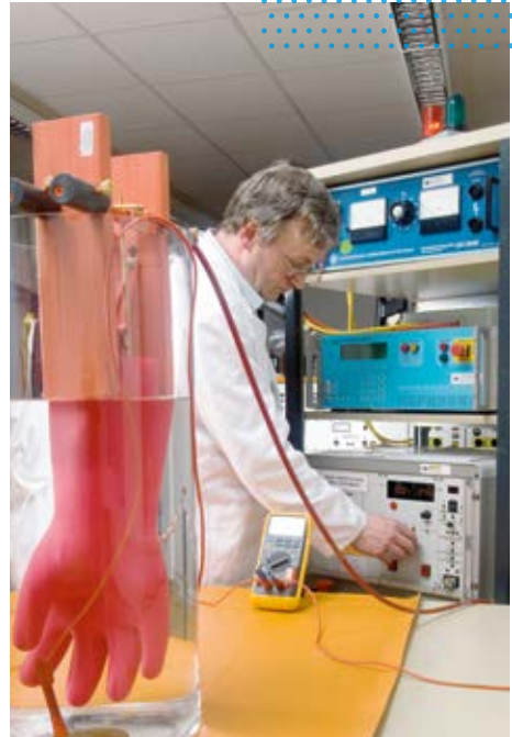
Isolationsprüfung an einem isolierenden Handschuh mit Messung des Ableitstromes
