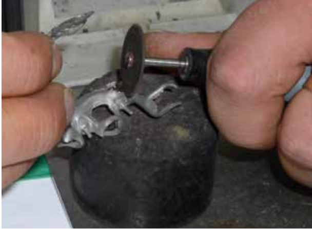
Bearbeiten von NE-Metallen mit Absaugung
