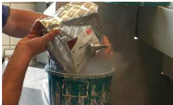
Staubentwicklung beim Umfüllen von Einbettmasse
