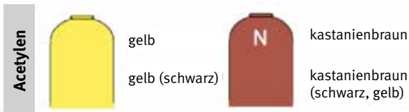
Bisherige (links) und neue Kennzeichnung von Acetylen
