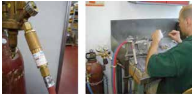
Die Sicherung gegen Flammrückschlag ist direkt nach dem Druckminderer an den Gasflaschen eingebaut.
