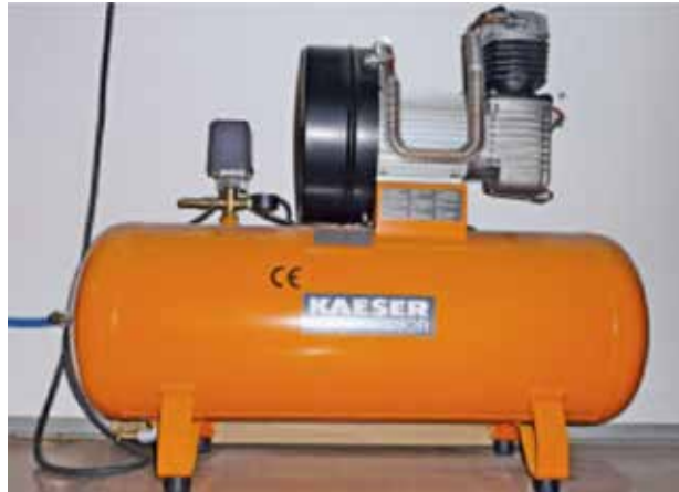
Verwendungsfertiges Druckgerät: Druckbehälter mit P \times V < 1.000 bar x Liter. Keine Prüfung vor Inbetriebnahme notwendig
