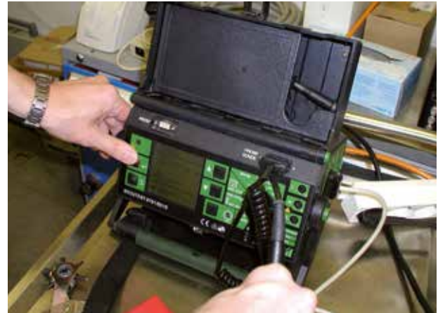
Prüfung der ortsveränderlichen elektrischen Betriebsmittel mit geeignetem Messgerät
