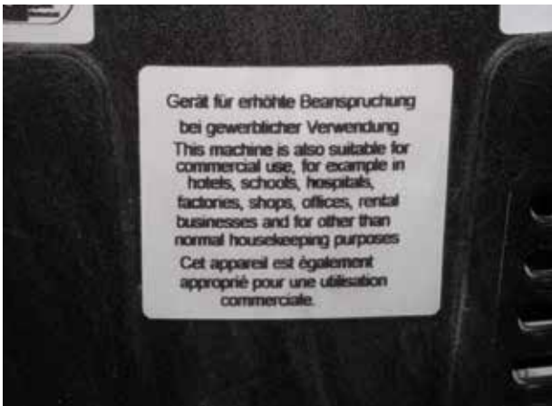
Ungeeigneter Entstauber für mineralische Stäube
