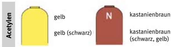
Bisherige (links) und neue Kennzeichnung von Acetylen
