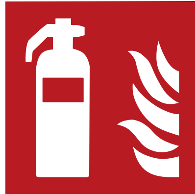
Das Brandschutzzeichen F001 weist auf den Standort des Feuerlöschers hin.
