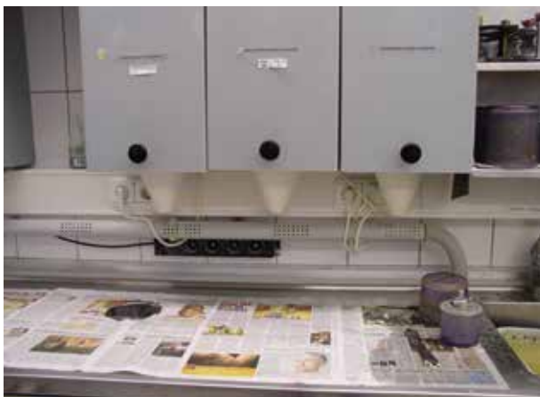
Abfüllen und Verarbeiten von Gipsen aus Silos
