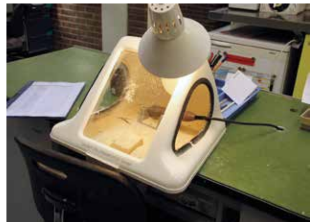
Bearbeiten von Gipsmodellen mit Absaugung
