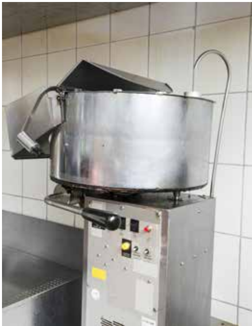
Arbeitsmittel mit heißen Oberflächen sind mit geeigneten Griffen ausgestattet.
