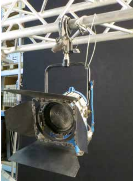
Scheinwerfer mit Sicherungsseil (Safety)
