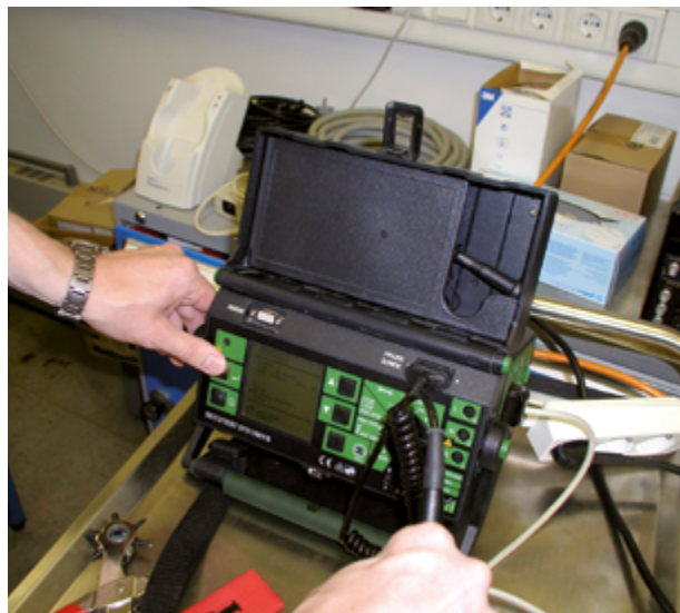
Prüfung der ortsveränderlichen elektrischen Betriebsmittel mit geeignetem Messgerät
