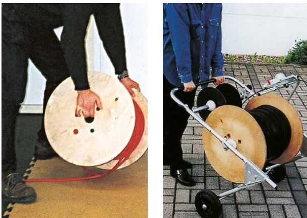
Diese Kabeltrommel mit 1.000 m 3x1,5 mm 2 wiegt ca. 70 kg. Wenn der Monteur die Trommel beim Ausrollen wendet, werden die Lendenwirbel mit ca. 325 kg belastet. Eine Ausroll- und Transporthilfe entlastet die Wirbelsäule.
