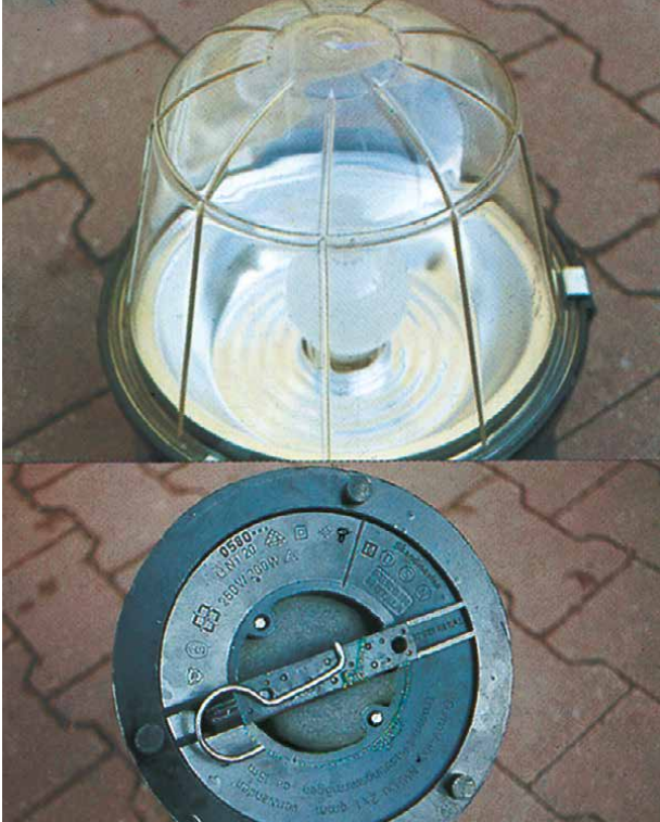
Vorschriftsmäßige und gut verwendbare Baustellenleuchte
