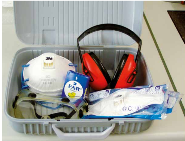
Immer griffbereit und sauber gelagert: Die persönliche Schutzausrüstung (PSA) fürs Stemmen, Fräsen, Schlitzen und Bohren.
