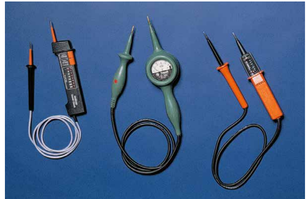
Verschiedene Bauformen von zweipoligen Spannungsprüfern
