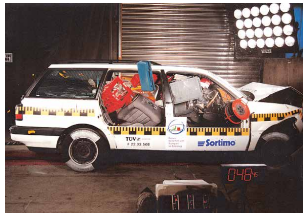
Sicherer Transport erfordert gesicherte Ladung. Was Fahrer und Beifahrer ansonsten gegen den Kopf knallt, zeigt dieser Crashtest.
