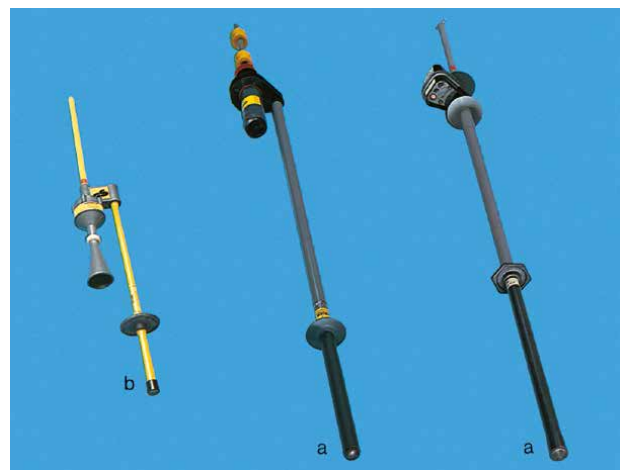
Spannungsprüfer b mit akustischer Anzeige, a mit optischer Anzeige
