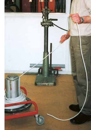
Bei einem Rollengewicht von rund 13 kg wirken in der Haltung links ca. 90 kg auf die Lendenwirbel. Mit der Transport- und Ausrollhilfe ist die Belastung minimal.
