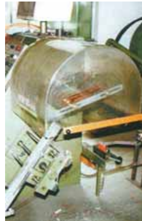
Wickelmaschinen mit Schutzhaube
