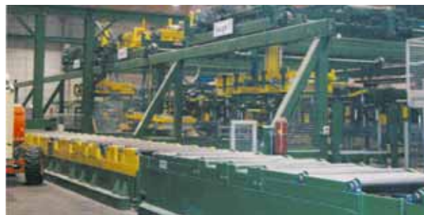
Transportstrecke mit Hubkästen
