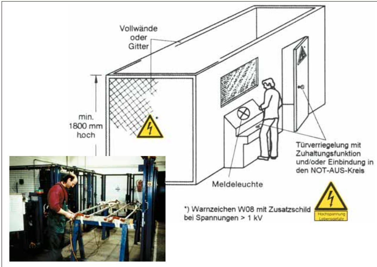
Abbildung und Schema eines betretbaren Prüfplatzes mit zwangsläufigem Berührungsschutz
