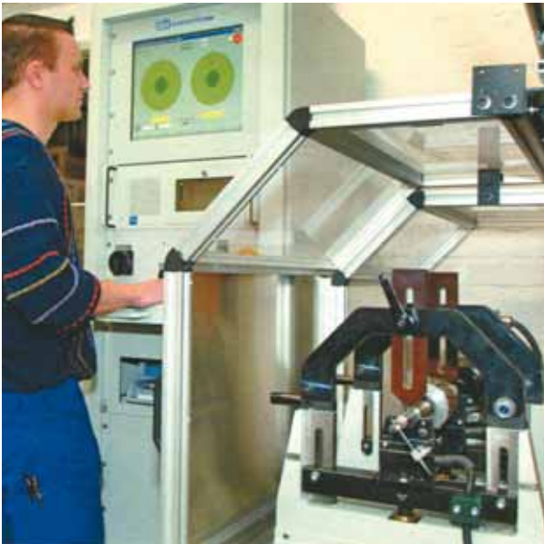
Der beste Schutz vor wegfliegenden Teilen ist die Einkapselung der Auswuchtanlage.
