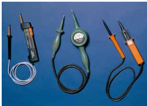
Verschiedene Bauformen von zweipoligen Spannungsprüfern
