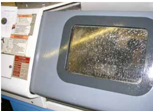
Diese geborstene Scheibe war einmal eine wirksame „fangende Schutzeinrichtung“. Das nächste Fräserbruchstück schlägt garantiert durch ...
