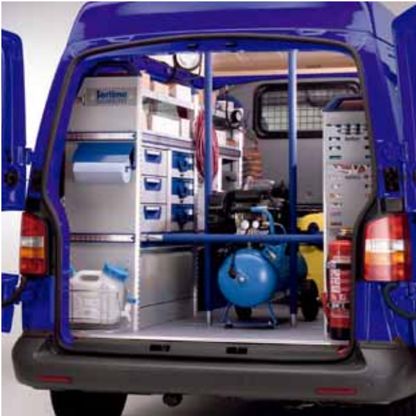
Hier ist ein schweres Aggregat mit Spannstangen gegen Verrutschen gesichert.
