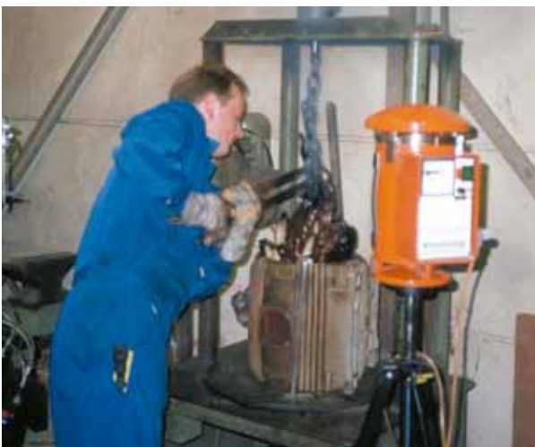
Messungen beim Herausziehen der Wicklungen nach thermischer Vorbehandlung
