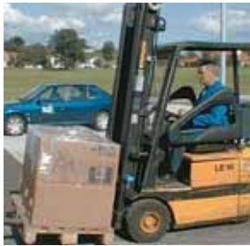
Stapler mit Fahrerschutzdach seitlichen Schutzbügeln
