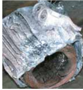
Bei der Explosion eines Entisolierofens wurden dieser Motor und Teile der Werkstatt zerstört. Zum Glück waren keine Mitarbeiter in der Nähe, so dass es bei einem hohen Sachschaden und einer mehrtägigen Betriebsunterbrechung blieb.
