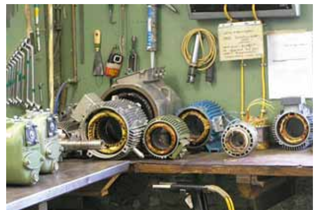
Beispielhafte Gewichte von Elektromotoren: 550 W = ca. 8 kg, 3 Kw = ca. 18 kg, 15 Kw = ca. 60 kg
