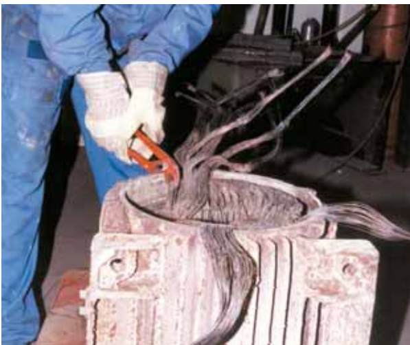
Mechanisches Herausreißen alter Wicklungen
