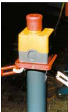
Not-Aus-Schalter außerhalb des Prüfbereichs
