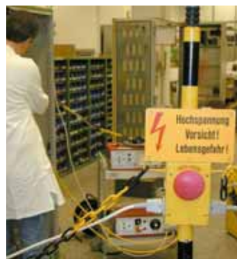
Not-Aus-Schalter außerhalb des Prüfbereichs
