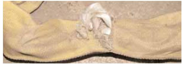
Ablegereif: Ummantelung und Einlage dieser Rundschlinge sind durch Schnitte stark beschädigt.
