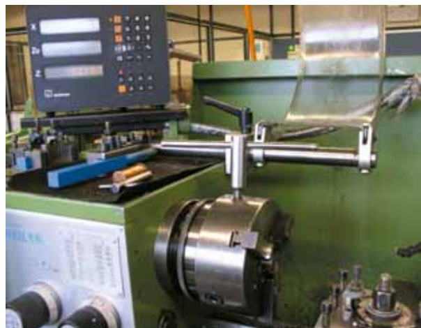
Hier hat einer den Futterschlüssel stecken gelassen. Beim nächsten Einschalten der Maschine kann der Schlüssel durch die Werkstatt fliegen. Besser sind selbstausdrückende Ausführungen, die nie vergessen werden können.
