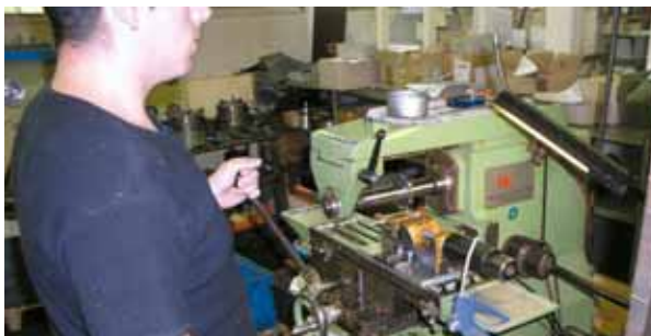
Fräsmaschinen mit ungeschütztem Fräs Werkzeug sind sehr gefährlich. Deshalb Fräser beim Werkstückwechsel ausschalten. Hände immer außerhalb des Gefahrenbereiches halten.
