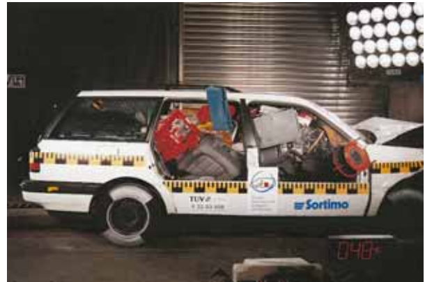
Sicherer Transport erfordert gesicherte Ladung. Was dem Fahrer und Beifahrer ansonsten gegen den Kopf knallt, zeigt dieser Crashtest.
