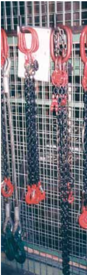
Vorbildlich geordnetes Kettengehänge mit Belastungstabellen.
