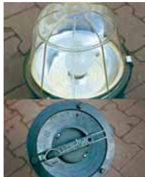
Vorschriftsmäßige und gut verwendbare Baustellenleuchte
