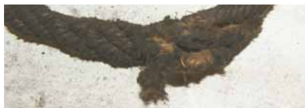
Eine zerstörte Litze, die das wichtige Fasermehl verliert.
