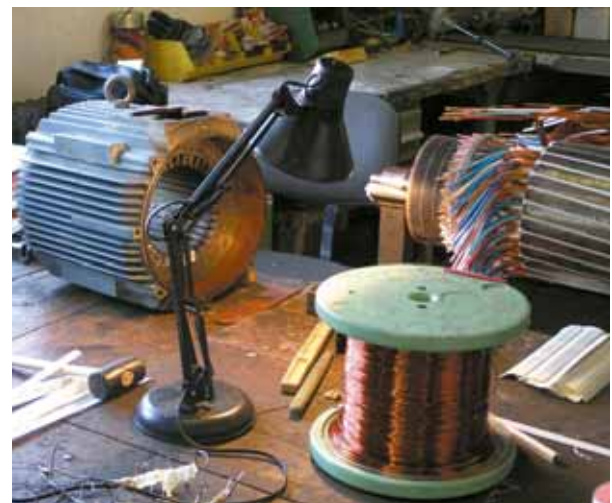
Ungeeignete Beleuchtung in einer Wickelei.
