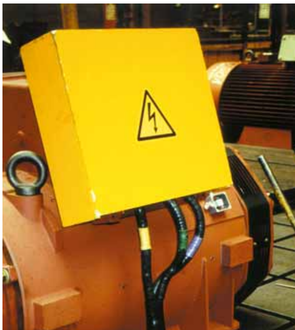
Prüfaufbauten mit Schutzmaßnahmen gegen direktes Berühren
