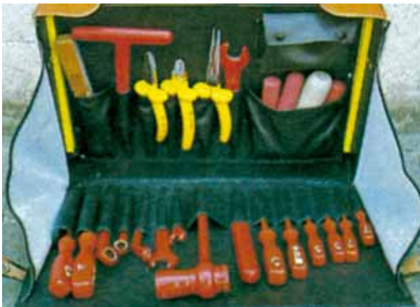
Werkzeugtasche mit isoliertem Werkzeug
