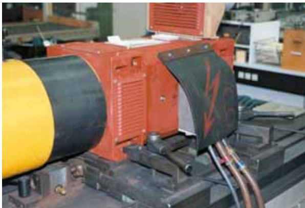
Prüfaufbauten mit Schutzmaßnahmen gegen direktes Berühren
