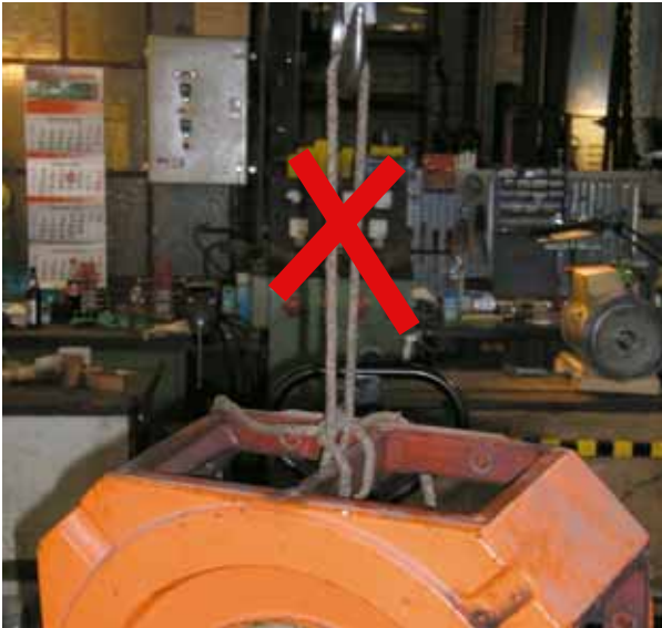
Keine Knoten in Seile, Ketten, Hebebänder und Rundschnigen machen!
