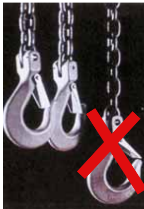
Die Maulöffnung des rechten Hakens ist um mindestens 10 % erweitert, die Klappe schließt nicht mehr.
