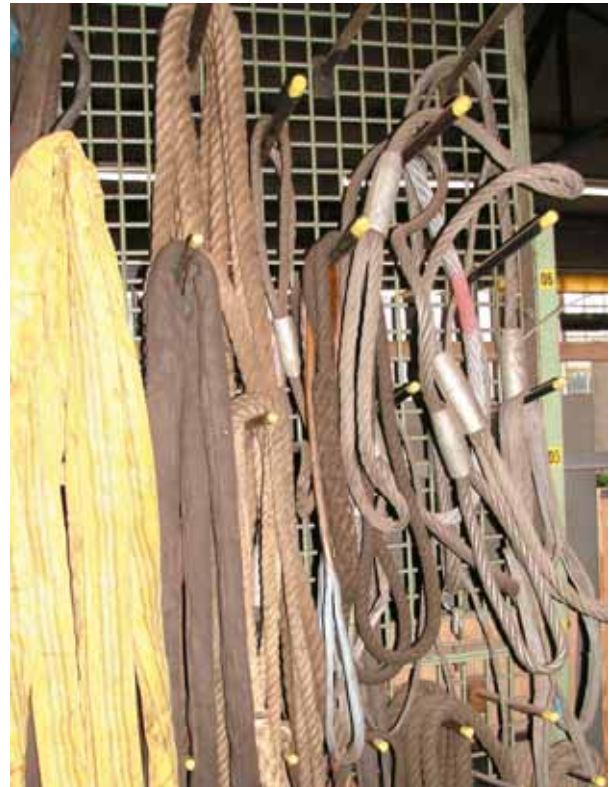
Eine gute Auswahl für Transportaufgaben mit einem Hebezeug: Seile, Hebebänder und Rundschlingen.
