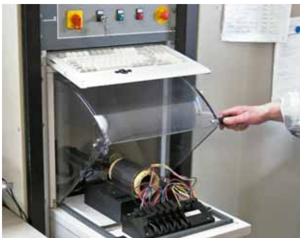
Prüfplatz mit zwangsläufigem Berührungsschutz (Abdeckung)
