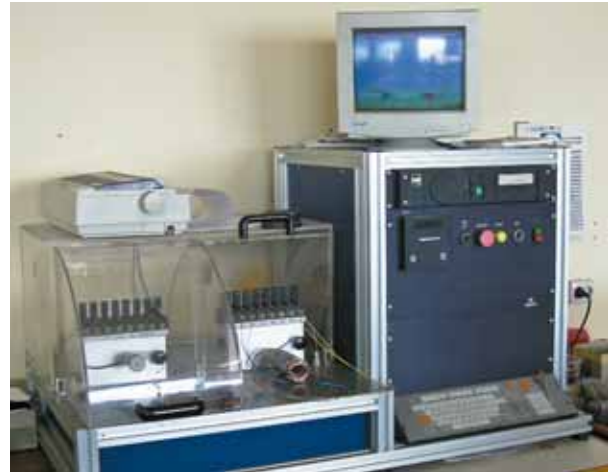
Prüfplatz mit zwangsläufigem Berührungsschutz (Abdeckung)
