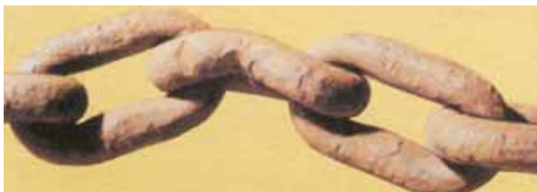
Kette mit verbogenem und eingekerbtem Kettenglied
