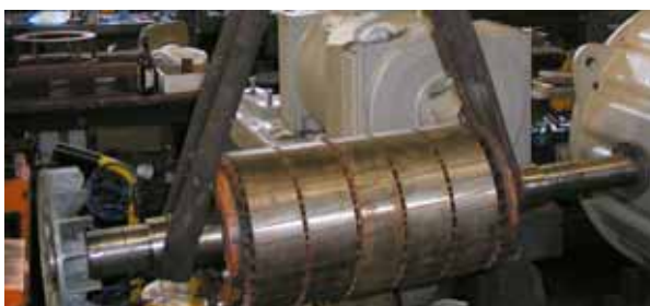
Hebebänder als Anschlagmittel im Elektromaschinenbau
