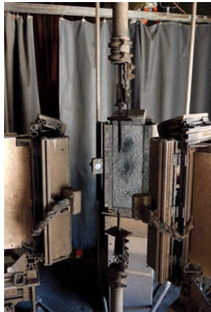
Bild 5.2: Prüfanordnung für den Arc-Rating-Test (mit Elektrodenanordnung sowie Probenhalterungen und Kalorimetern im Umkreis)
