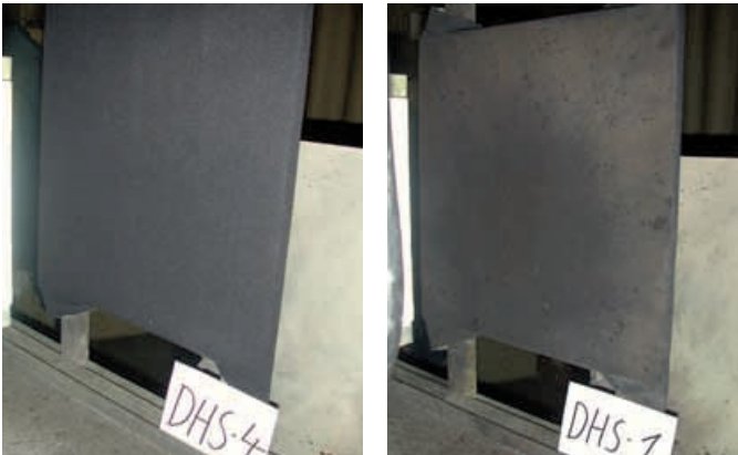
Bild 5.4: Messergebnis einer Prüfung des Boxtests für Klasse 2 eines 2-lagigen Textilmaterialsystems (oben) und Prüflinge vor (links unten) und nach dem Test (rechts unten)
