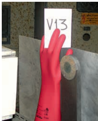
Bild 7.2: Boxtest-Aufbau für die Handschuhprüfung mit Handschuhhalterungen mit Kalorimetern
