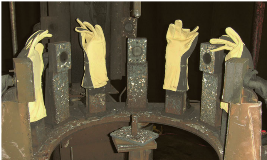
Fig. 7.1: Montaje del ensayo para guantes de protección con adaptación del método de ensayo Arc-Rating-Test (fuente: Dehn+Söhne GmbH + Co. KG Neumarkt/ Alemania)
