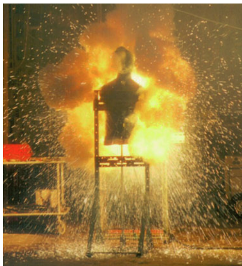
Fig. 5.1: Maniquí de ensayo con una chaqueta que ha sido expuesto a un ensayo en caja (Box-Test)
