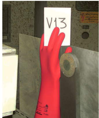
Fig. 7.2: Montaje del ensayo en caja (Box-Test) para la prueba de guantes con paneles para guantes provistos de calorímetros
