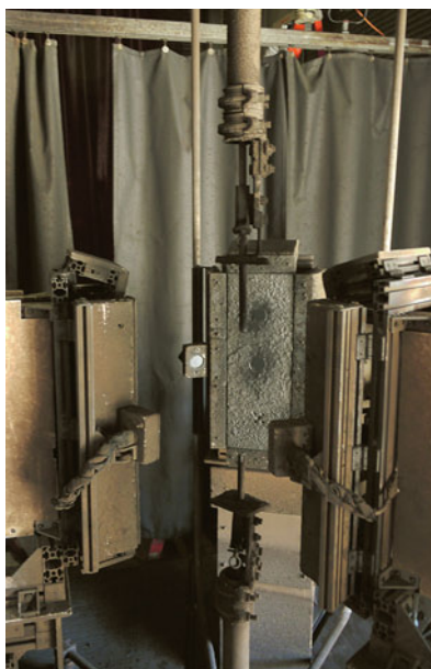
Fig. 5.2: Disposición del ensayo para el método de ensayo Arc-Rating-Test (con la distribución de los electrodos, las placas portadoras de muestras y los calorímetros a su alrededor)
