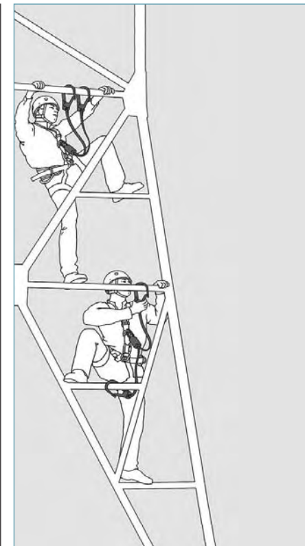
фиг. 17: Достъп чрез конструкцията
