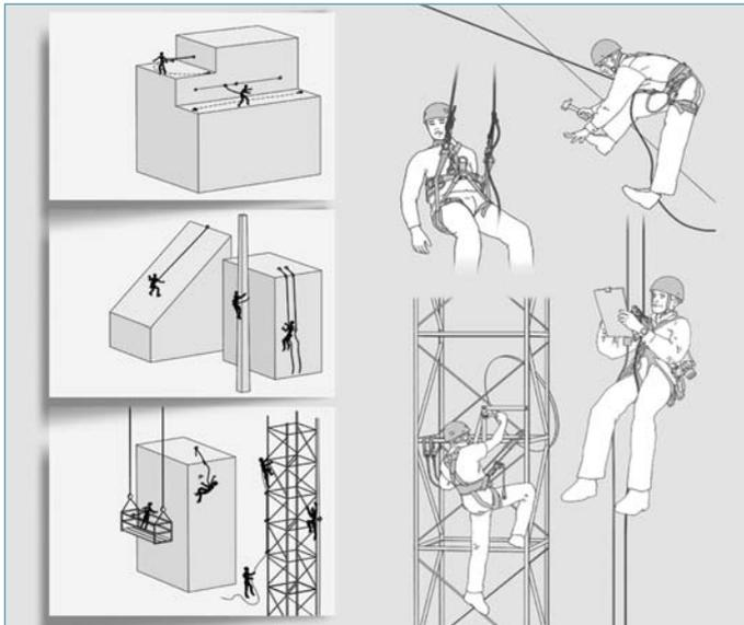
Figura 17: Ejemplos de métodos de trabajo y de acceso con ayuda de cuerdas
