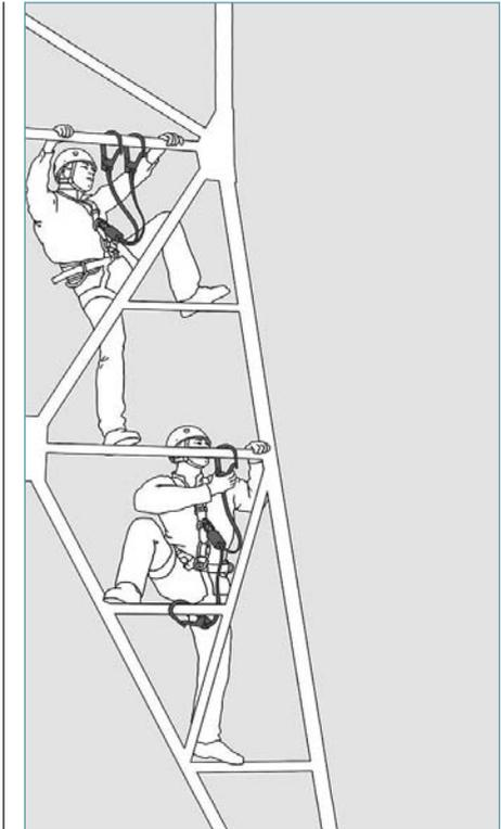
Figura 18: Elección de los puntos de sujeción
