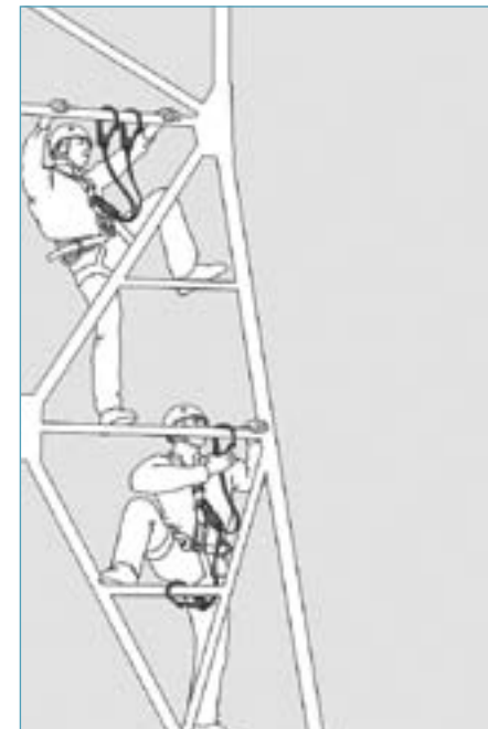
Obr. 18: Příklad přístupu po konstrukci
