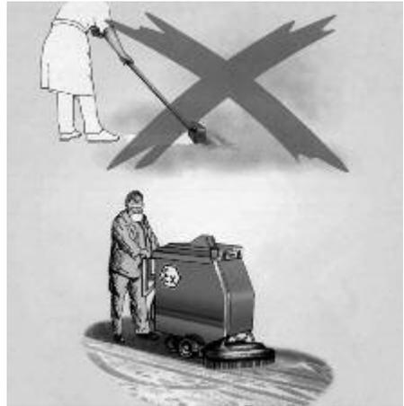
**Bild 3: Ungeeignetes und geeignetes Verfahren zur Beseitigung von brennbarem Staub**
