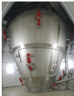
Δοχείο με ενσωματωμένο εξοπλισμό καταστολής της έκρηξης
