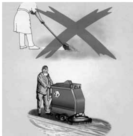
Slika 3: Neispravan i ispravan i na in uklanjanja prašine
