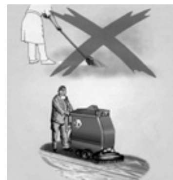
Obrázek 3: Nevhodný a vhodný způsob odstranění hořlavého prachu
