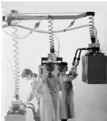
Slika 8: Pomcanje tereta vakumskim ure ajem za dizanje
