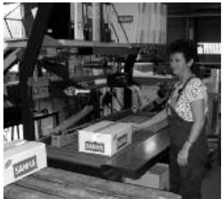
Slika 10: Zaštita pri aktivnostima podizanja i prenošenja korištenjem vertikalno podesivih radnih stolova i valjkastih transportera
