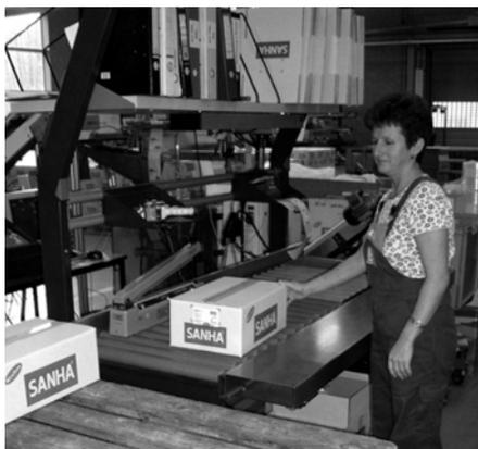
**Figura 10: Evitar acciones de levantamiento y sujeción mediante mesas de trabajo ajustables en la altura y bandas de rodamiento**
