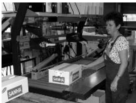
Bild 10: Vermeidung von Hebe- und Trageaktionen durch höhenverstellbare Arbeitstische und Rollbänder
