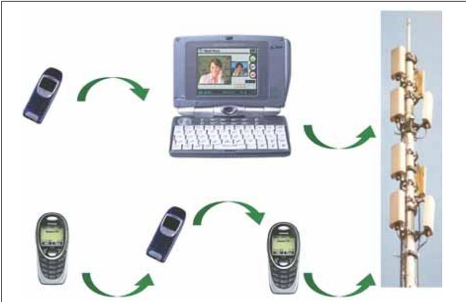
Abb. 3: Reduktion der Sendeleistung durch Verwendung multi-hop-fähiger Endgeräte. Aufgrund geringer Distanzen zu einem benachbarten Endgerät wird nur eine kleine Sendeleistung benötigt.
