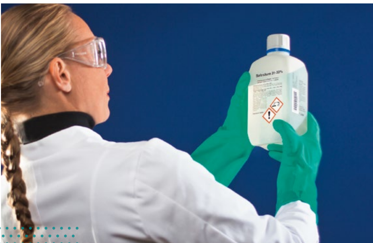
Abbildung 12: Erste Hinweise zu den Eigenschaften von Gefahrstoffen liefert u. a. die Kennzeichnung auf dem Gebinde.
