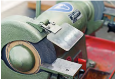
Schleifbock mit Schutzhaube und Fenster aus nichtsplitterndem Glas
