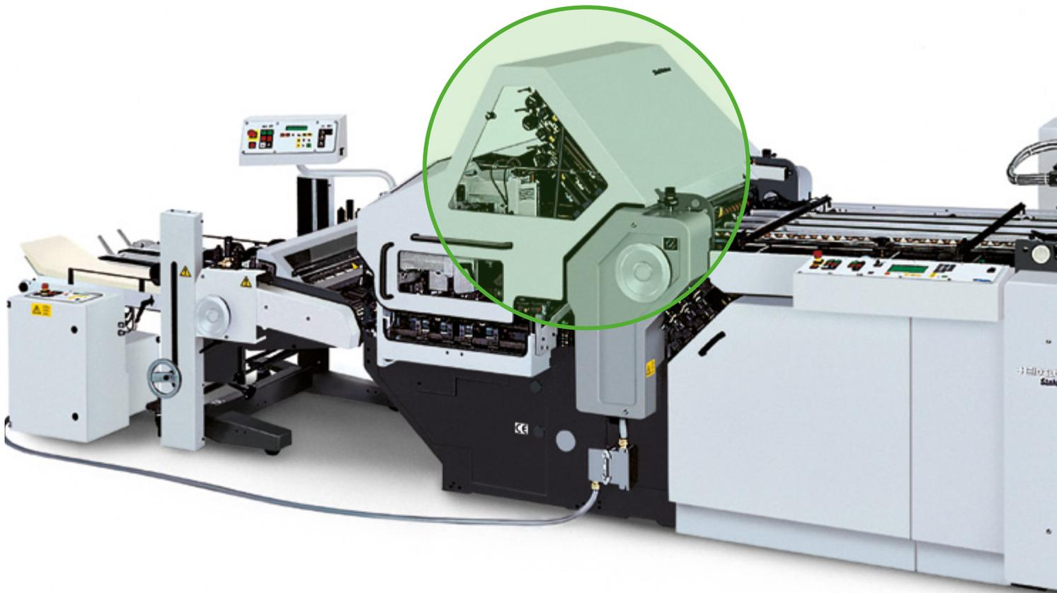
Schallschutzhaube an einer Kombifalzmaschine
