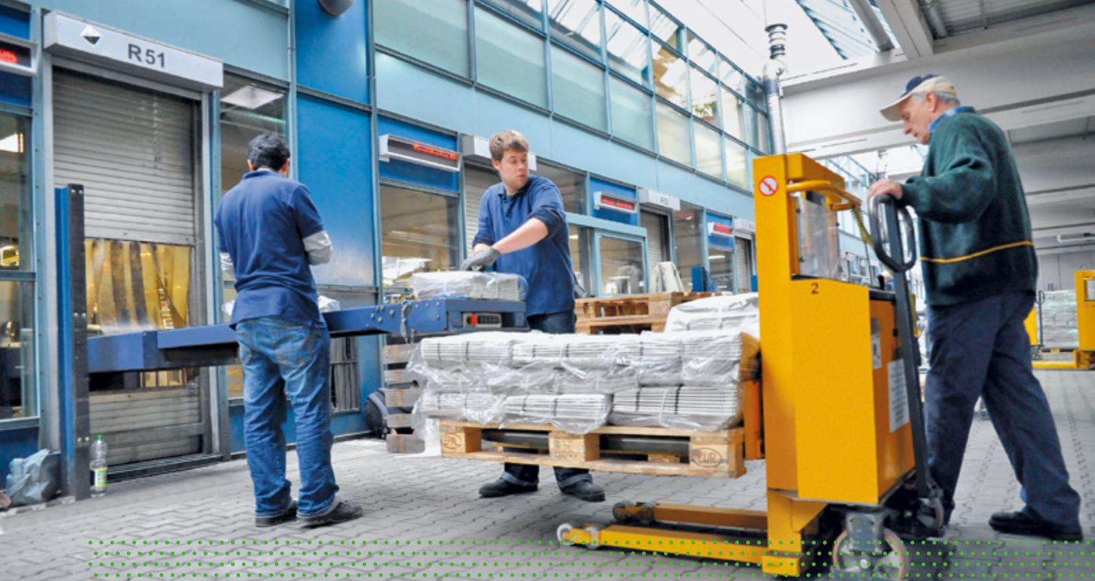
Stapelhilfen wie z. B. Hubtische ermöglichen ergonomisch richtige Arbeitshöhen zum Ab stapeln.
