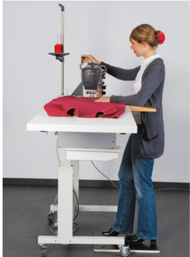
Höhenverstellbarer Näharbeitsplatz: Je nach Arbeitsaufgabe und Körpergröße ist die Höhe einstellbar. Der ausreichende Beinfreiraum ermöglicht komfortables Sitzen und Stehen. Die Tischplatte wurde zur Auflage der Unterarme beidseits erweitert. Dies dient der Entlastung der Nacken-, Schulter- und Armmuskulatur.
