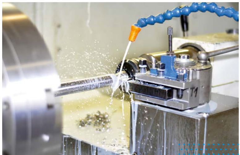
Kühlschmierstoffe können durch schnelllaufende Werkzeuge oder Maschinen als gesundheitsschädliche Aerosole freigesetzt werden.
