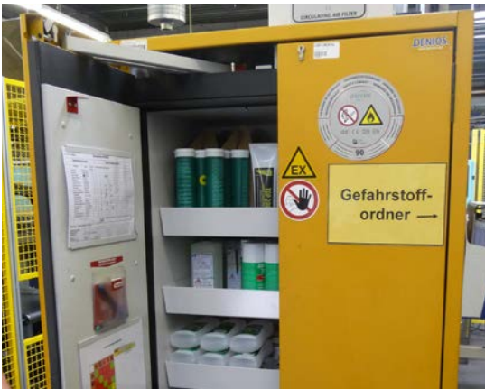
Gefahrstoffe, die nicht für den Arbeitsvorgang benötigt werden, gehören in den Gefahrstoffschrank.
