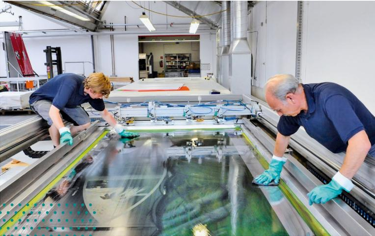
Siebreinigung in der Maschine
