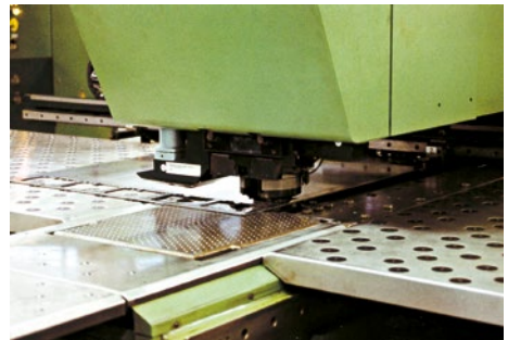
Abb. 7: Entstehung von Ölnebel und -dampf beim Automaten-Stanzen
