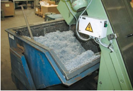
Abb. 12: Ungehindertes Abdunsten von KSS aus Spänewagen. Die Späne bilden eine große Oberfläche.
