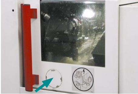
Abb. 38: Sollbruchstelle in der Maschinenkapselung, um bei geschlossener Kapselung mit einem Handfeuerlöscher zusätzlich löschen zu können.
