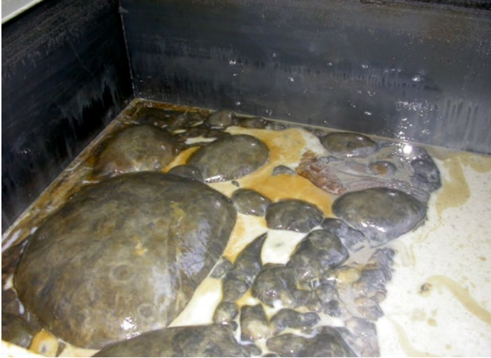
Abb. 43: Stark geschädigter wassergemischter KSS, bei dem das aufschwimmende Fremdöl durch mikrobielle Aktivität (Gasbildung) aufgebläht ist.
