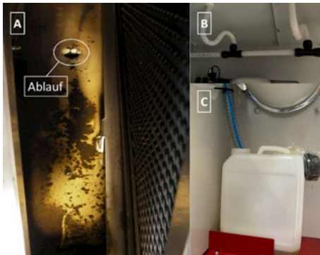
Abb. 23: Sammlung des abgeschiedenen KSS an einem Abscheider. Bild A zeigt den abgeschiedenen KSS auf dem Boden der Filteranlage, Bild B die Rücklaufleitungen mit Geruchsverschluss und Bild C den Sammelkanister. Die Füllstandskontrolle des Kanisters ist in den Prüf- und Überwachungsplan der Maschine mit aufzunehmen.
