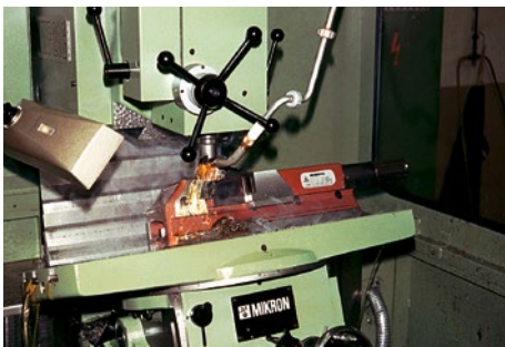
Abb. 8: Entstehung von Öldampf und -rauch an einer Fräsmaschine
