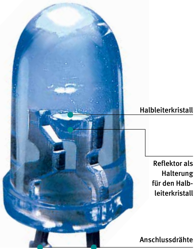
Aufbau einer LED-Lichtquelle
