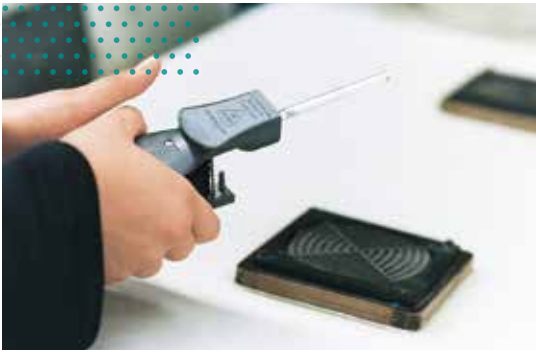
Einfache Messung der Ozonkonzentration mit einem Prüfröhrchen.
