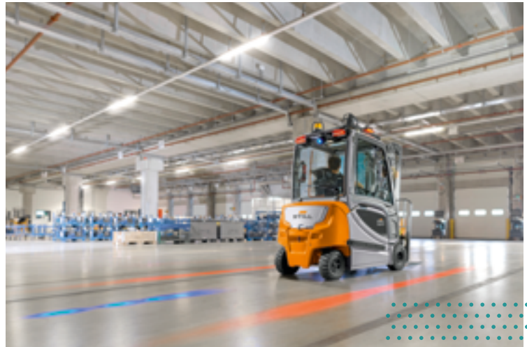
Leuchtstreifen warnen vor dem Gabelstapler.
