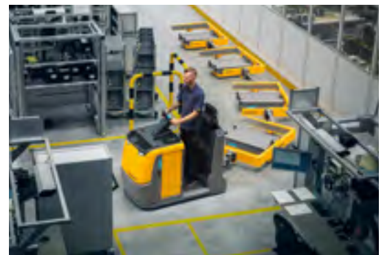
Ein Routenzug besteht aus Schlepper und Anhänger(n).
