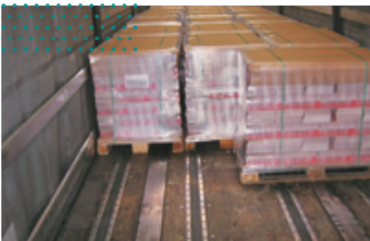
Durchführung der formschlüssigen Beladung auf einem Lkw
