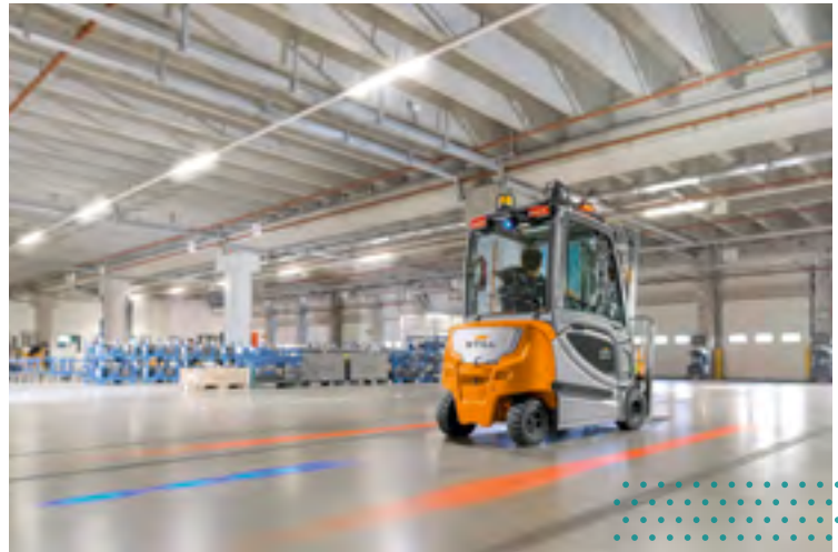
Leuchtstreifen warnen vor dem Gabelstapler.
