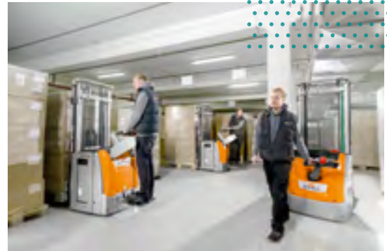
Mitgänger-Flurförderzeuge mit und ohne klappbarer Fahrerstandplattform
