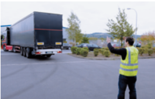
Einweiser außerhalb des Gefahrenbereichs mit Warnweste
