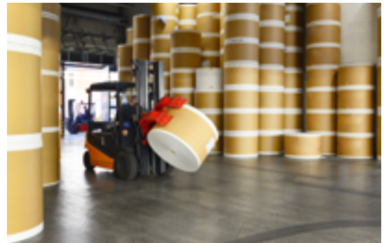
Verladen von Papierrollen per Gabelstapler mit Rollenklammer
