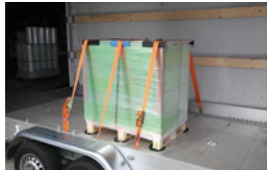
Sicherung einer Palette durch Niederzurren
