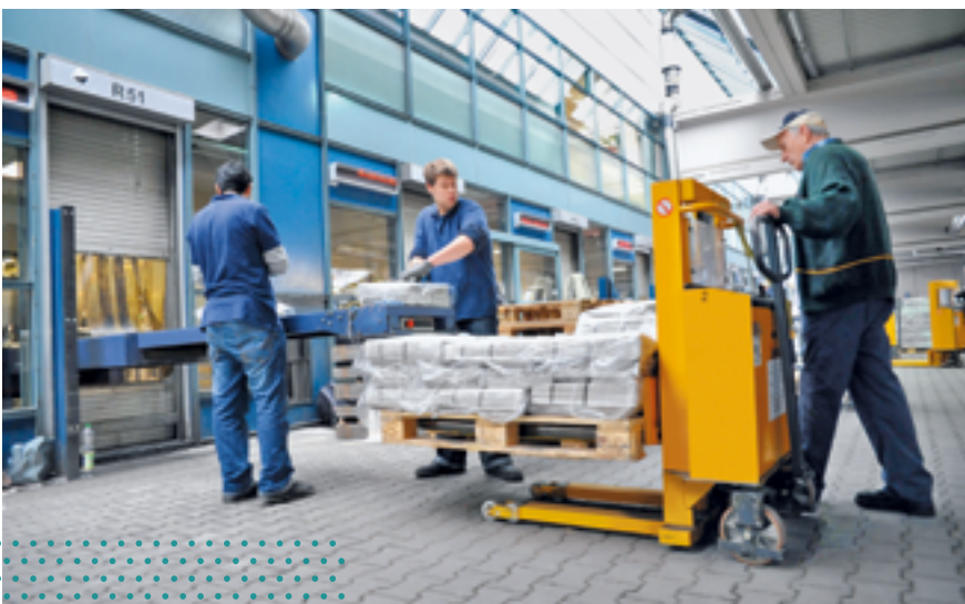
Höhenverstellbare Stapelhilfen ermöglichen ergonomisch richtige Arbeitshöhen zum Abstapeln.
