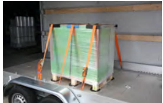
Sicherung einer Palette durch Niederzurren
