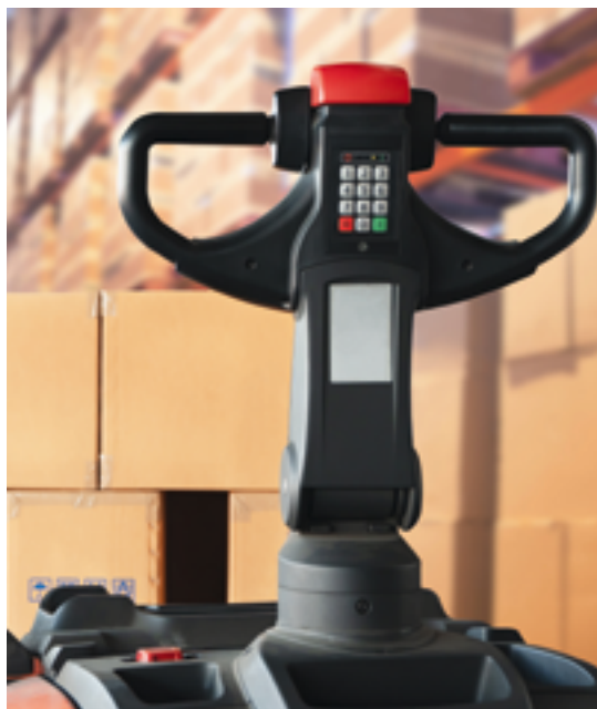
Ein PIN-Code anstatt eines Schlüssels schützt hier gegen unbefugtes Benutzen.
