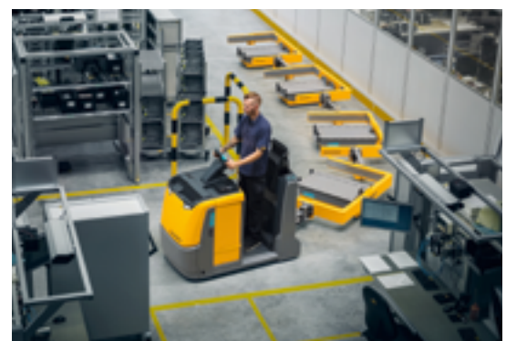
Ein Routenzug besteht aus Schlepper und Anhänger(n).
