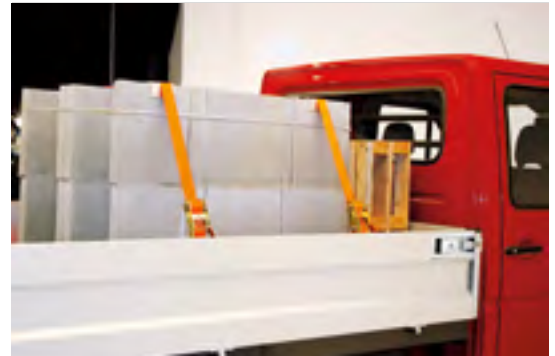
Kombinierte Ladungssicherung – z. B. durch Niederzurren und Formschluss mit Stirnwand
