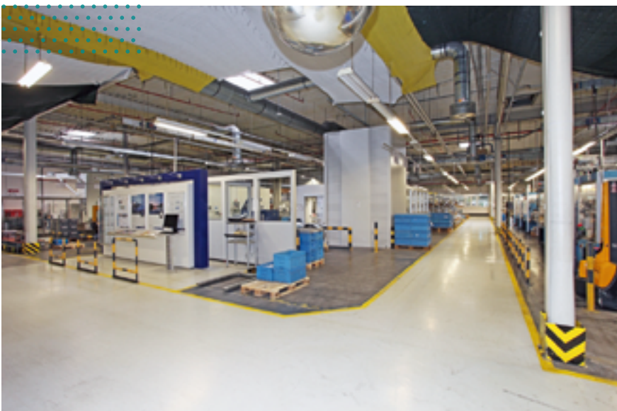
An unübersichtlichen Stellen auf Verkehrswegen mit Lastverkehr sollten Spiegel montiert werden (Kugelspiegel an der Hallendecke).
