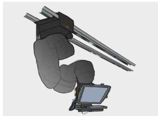
Abbildung 11: Kamera-Robotersystem mit Sechs-Achs-Steuerung an Deckenschienen verfahrbar, mit Schallschutz
