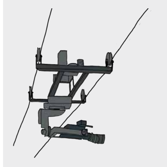
Abbildung 6: Lineares System mit zwei Tragseilen
