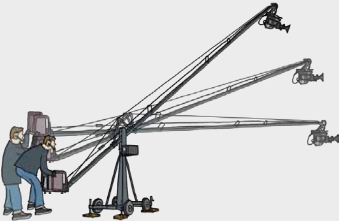
Abbildung 2: Kamerakran mit Dolly-Fuß in Bewegung
