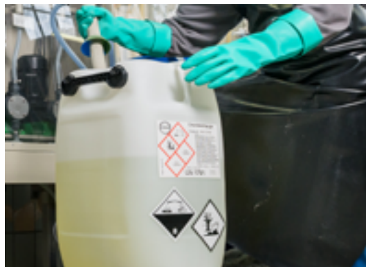
Die Gefahrstoff-Kennzeichnungen sind nur noch nach GHS weltweit zulässig – erkenntlich an der Rauten-Form.
