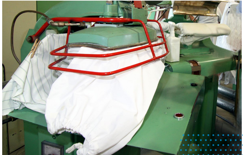
„Rot“ ist die Farbe für Not-Halt-Stellteile.
