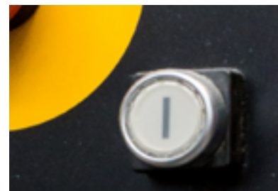
Der EIN-Schalter „I“ kann statt weiß (wie hier im Bild) auch grün sein.
