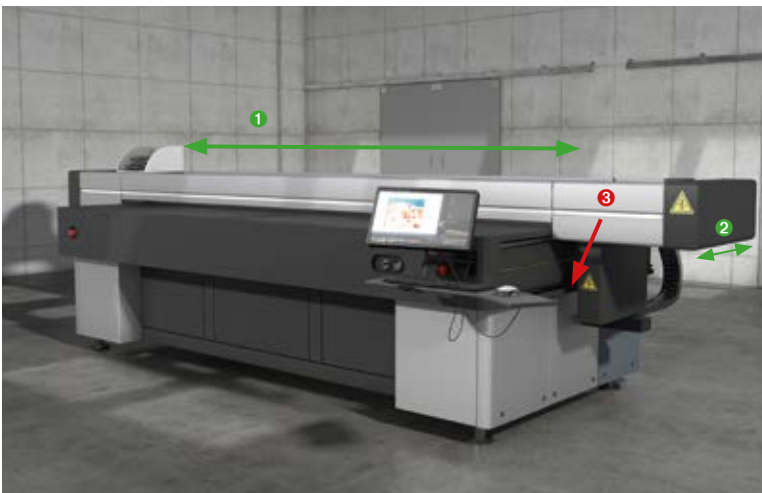
Ungesicherte Quetsch- und Scherstellen durch die Verfahrbewegung der Druckkopfbrücke
