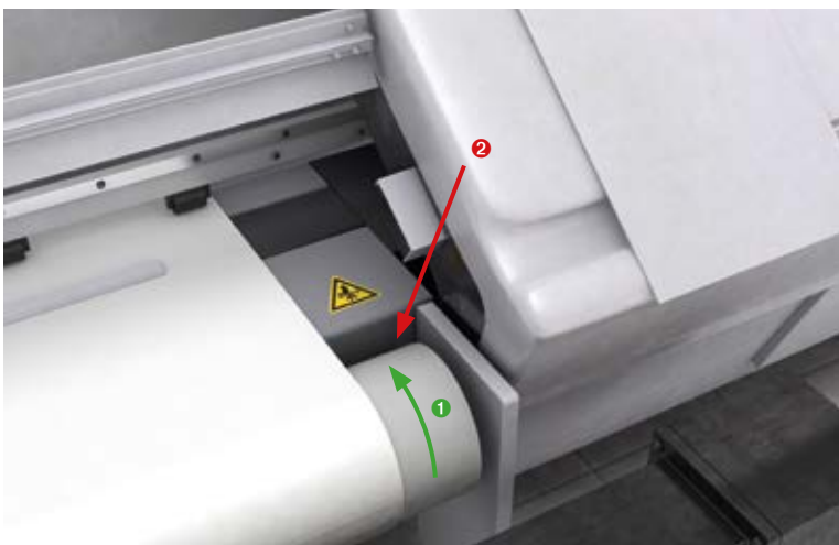
Ungesicherte Einzugsstelle zwischen Walze und Gehäuse
