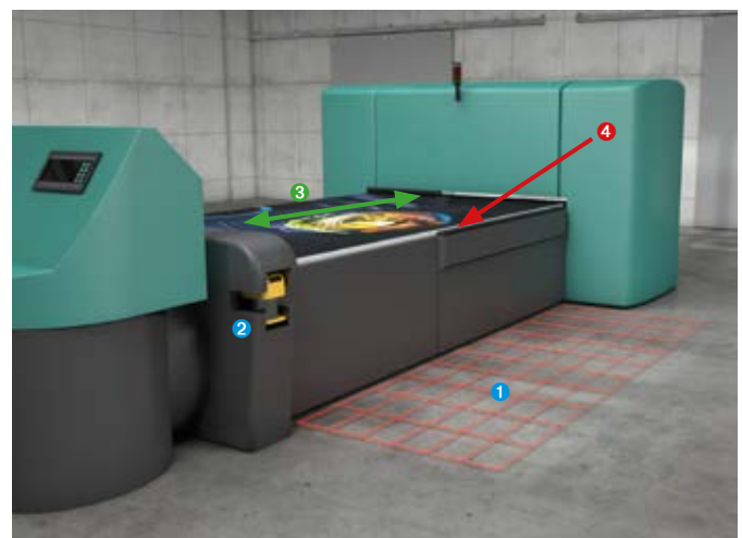
Sicherung durch BWS
