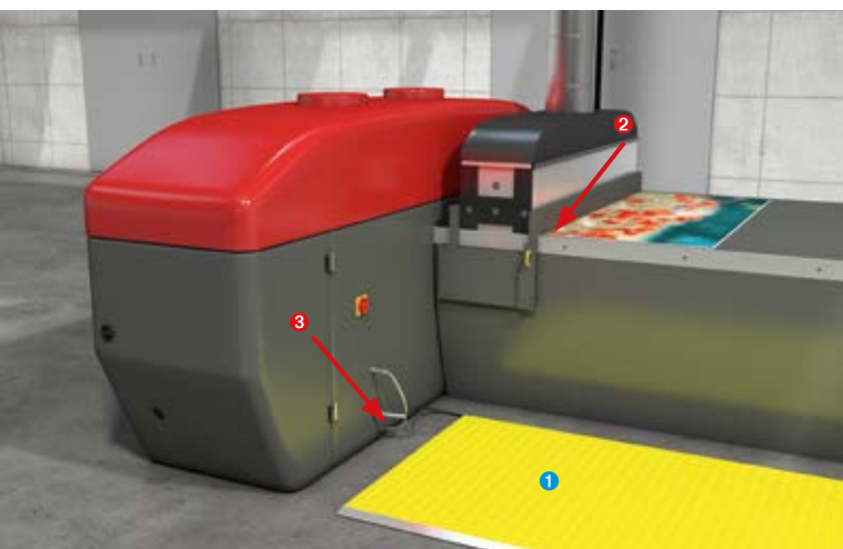
Unzureichende Sicherung durch eine Schaltmatte
